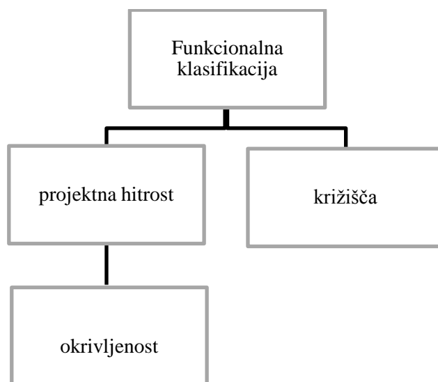
Grafikon 1: Faktorji, ki vplivajo na funkcionalno klasifikacijo (Flexibility in Highway Design, 1997: str. 44).
