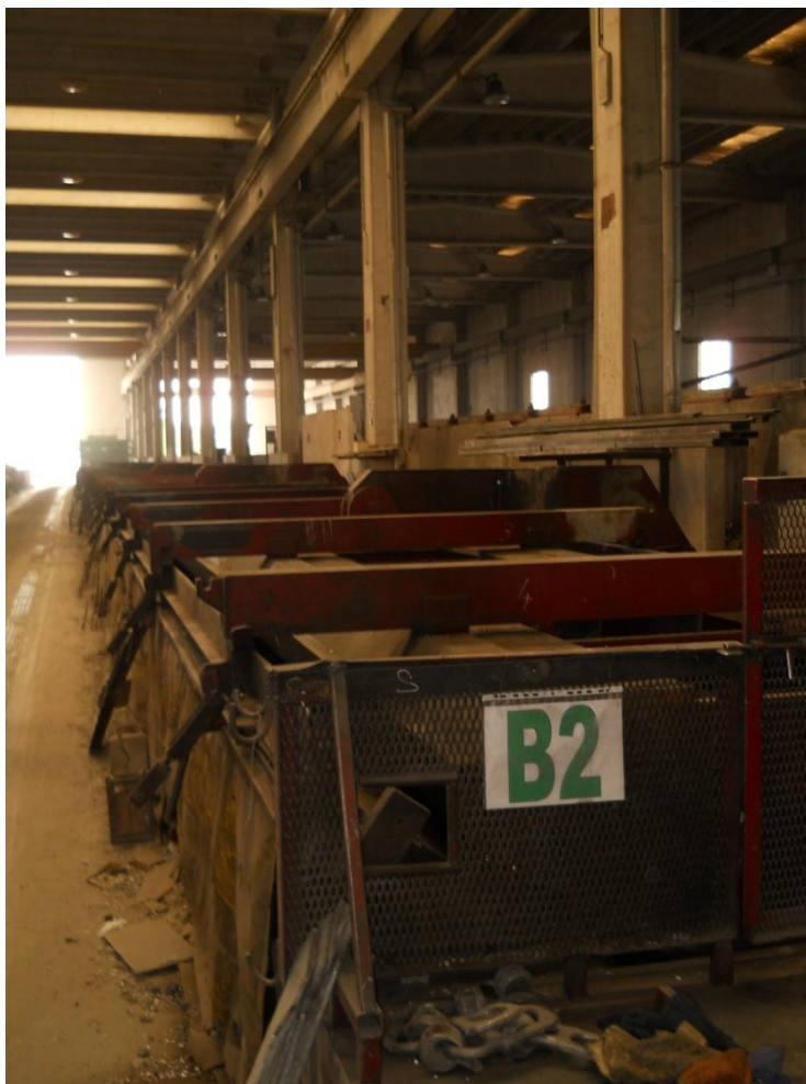
Slika 5: Napenjalna steza s kalupom za "V" nosilce tipa "Wing"
