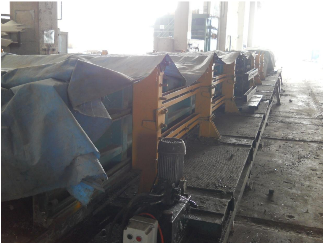
Slika 12: AB montažni element med procesom parjenja ter negovanja.
