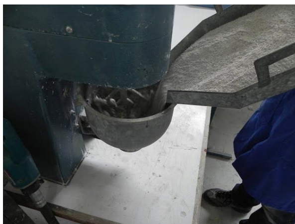
Slika 30: Priprava (mešanje) podaljšane cementne malte
