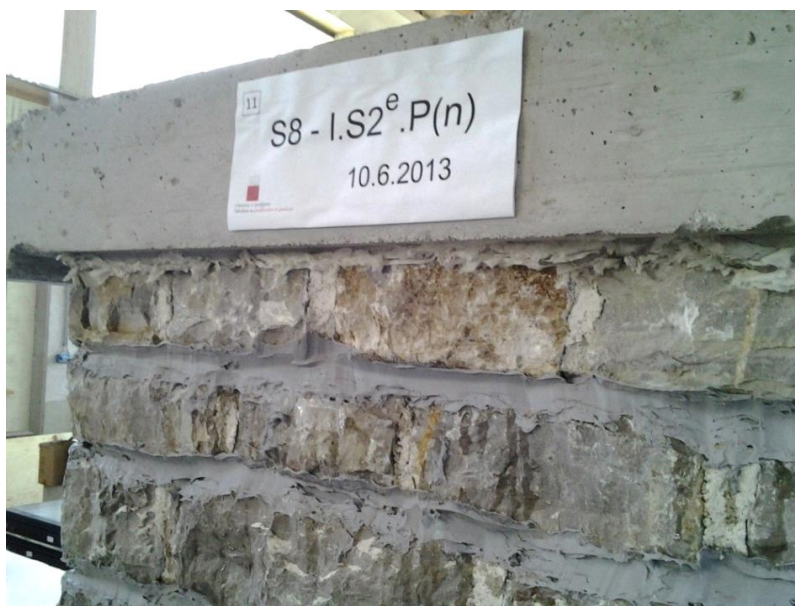
Slika 42: Vrvica, ki je z epoksidno malto vgrajena v spojnice zidu
