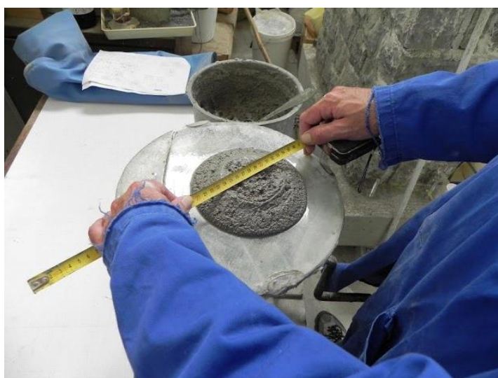
Slika 31: Merjenje razleza podaljšane cementne malte
