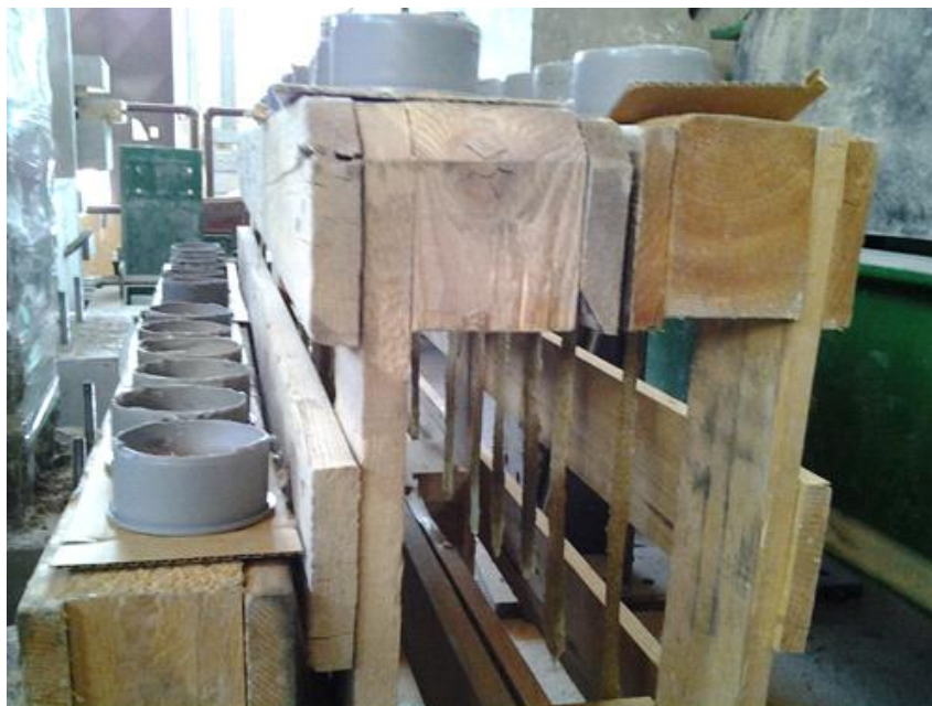
Slika 17: Sušenje impregnacijske epoksidne smole (utrjevanje) z vertikalnim položajem vrvice (prosto visenje)
