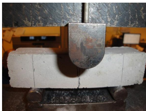
Slika 34: Testiranje upogibne trdnosti na prizmi iz cementne malte
