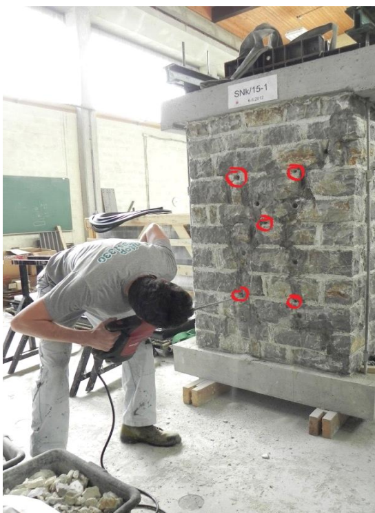
Slika 39: Prečno vrtnanje zidu z udarnim vrtnikom z označenimi izvrtinami
