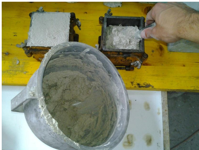
Slika 8: Malta Mape-Antique – vgradnja v kalup za tlačni preizkus
