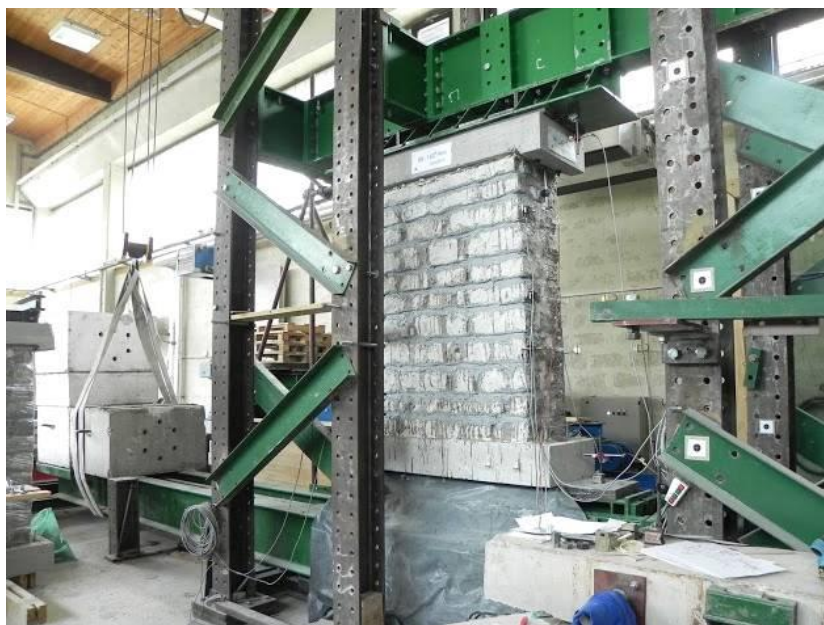
Slika 46: Vpetje zidu v napravo
