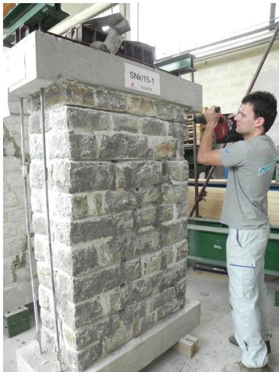
Slika 37: Poglobitev spojníc s pnevmatskim kladivom
