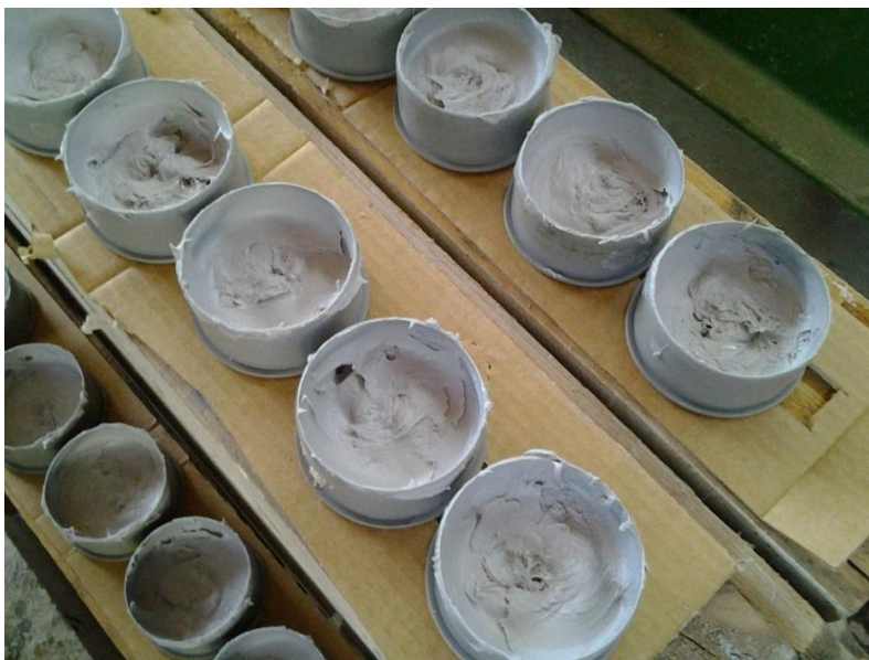
Slika 15: PVC čepi za sidranje vrvic iz steklenih vlaken z epoksidno malto
