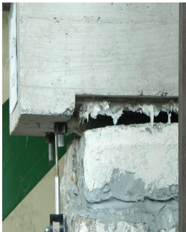
Slika 49: Odpiranje zidu ob merilcu V3
