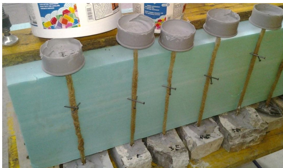
Slika 18: Vgradnja impregniranih vrvic s posutjem in PVC čepi v kamnite preizkušance ter pričvrstitev na XPS panel v fazi sušenja malte
