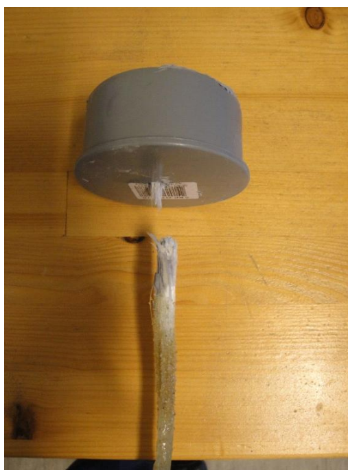
Slika 26: Tip porušitve D; pretrg vrvice
