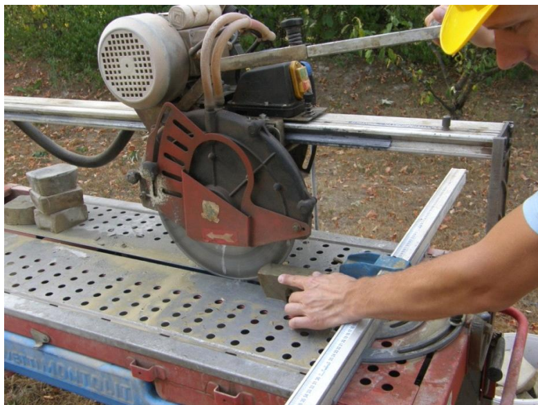
Slika 13: Rezanje preizkušanca iz peščenjaka
