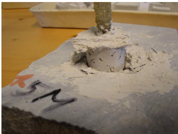
Slika 25: Tip porušitve B; porušitev na stiku malta-kamen
