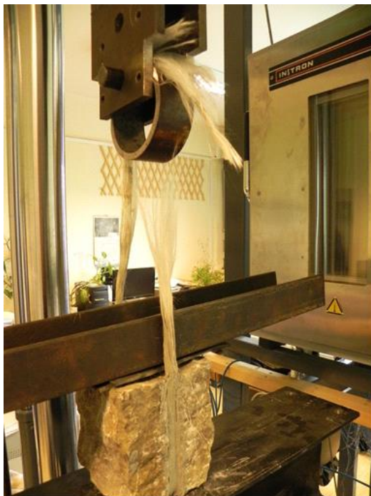
Slika 12: Preizkušavec z vrvice, vgrajeno z epoksidno smolo na površino utora (simulacija rege med dvema kamnitima blokoma)
