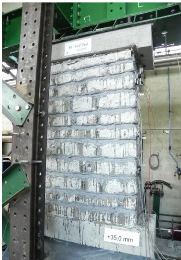
Slika 50: Odpiranje zidu zgoraj pri horizontalnem pomiku + 35 mm
