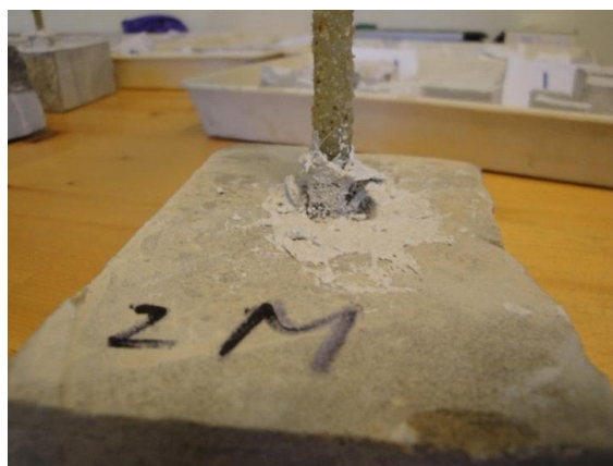
Slika 24: Tip porušitve A; porušitev malte
