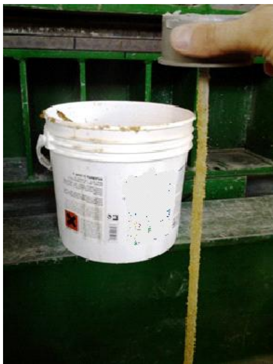
Slika 16: Impregnirana vrvica iz steklenih vlaken, posuta s suhim kremenčevim peskom
