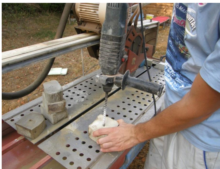
Slika 14: Vrtanje preizkušanca iz peščenjaka
