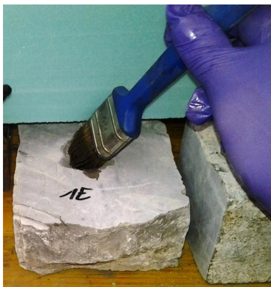
Slika 19: Nanos temeljno sprejemnega premaza MapeWrap Primer 1 na obodno površino izvrtine
