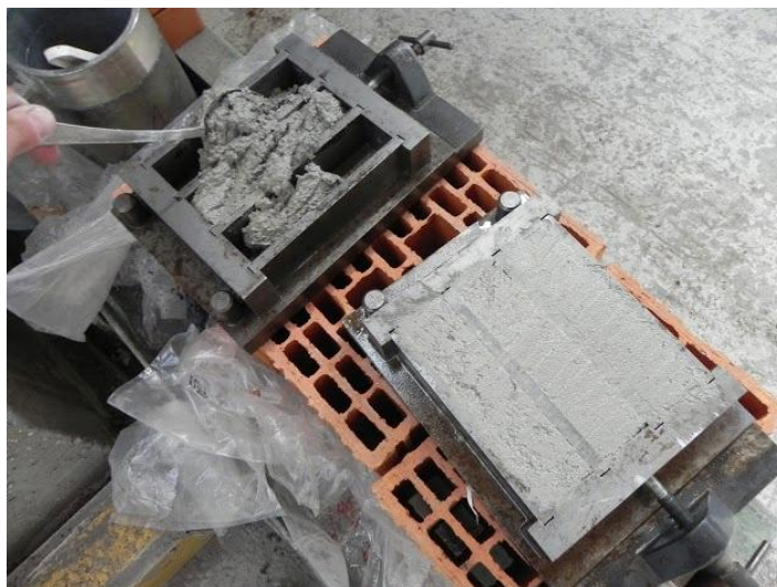
Slika 32: Vgradnja podaljšane cementne malte v kalupa
