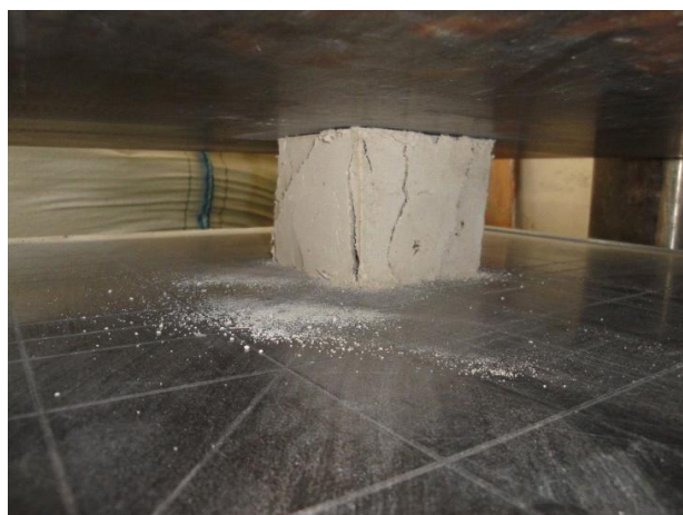
Slika 29: Test tlačne trdnosti malte Mape-Antique Strutturale NHL
