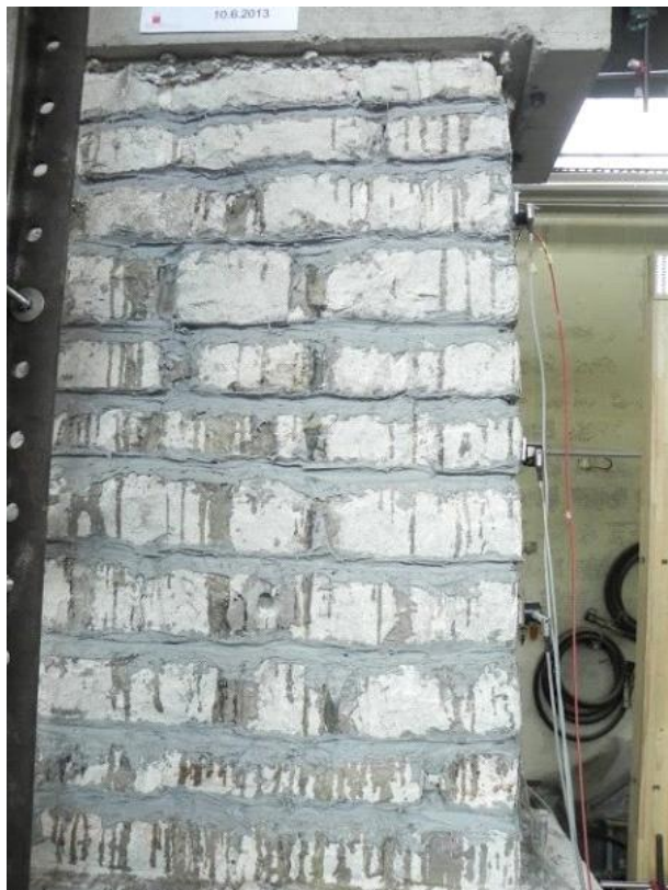
Slika 48: Zid med obremenjevanjem brez poškodb
