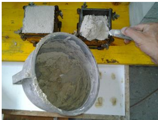
Slika 28: Vgradnja malte Mape-Antique Strutturale NHL v kalup iz kocke
