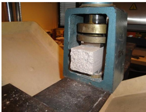
Slika 35: Testiranje tlačne trdnosti cementne malte
