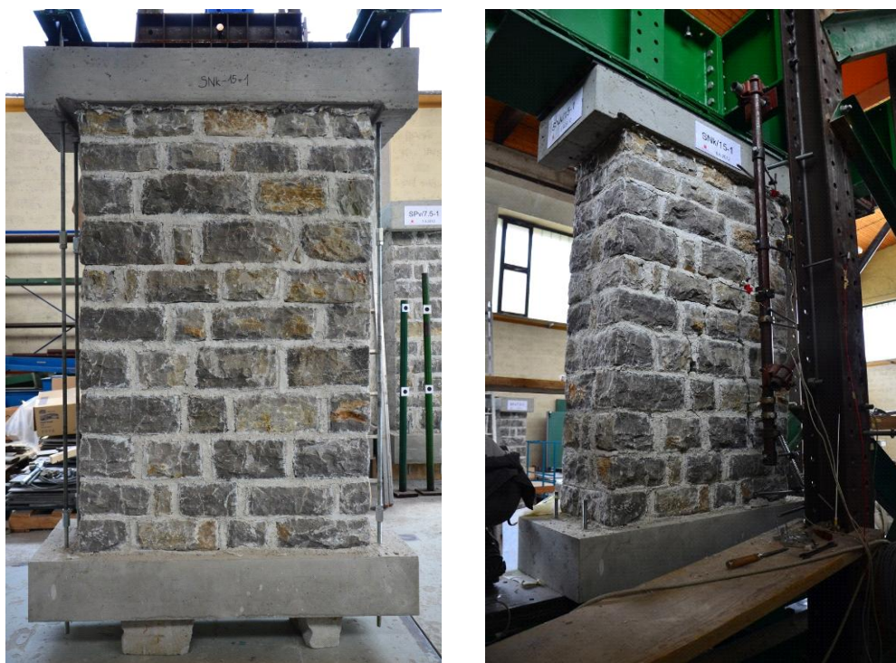
Slika 7: a) Neutrjeni zid pred preizkušanjem, b) Po strižnem preizkusu [11]
