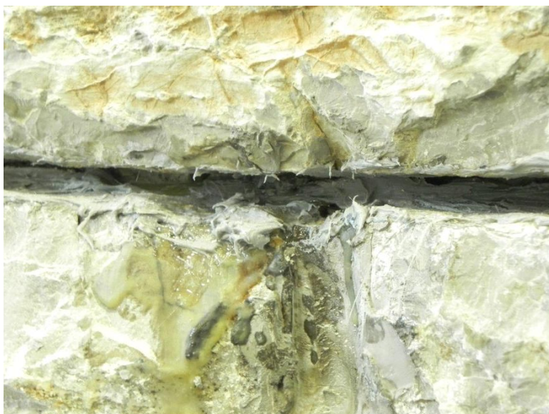
Slika 41: Razprostiranje vrvice, ki je bila vgrajena prečno skozi zid, v horizontalno spojnico, ki poteka vzdolž zidu
