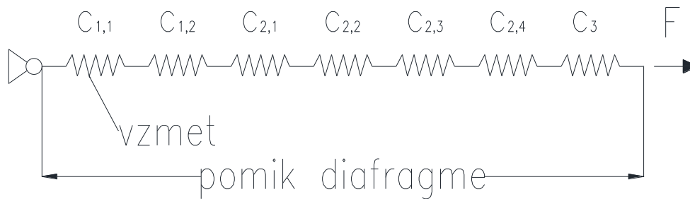
Slika 36: Deformacije v diafragmi – zaporedni sistem
