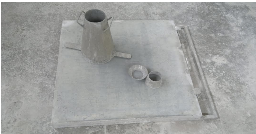
Slika 11: Podlaga in kalupa za izvajanje preizkusa razleza s posedom
