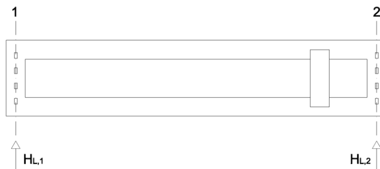
Slika 131: Vpliv mostnega dvigala na žerjavno povezje
