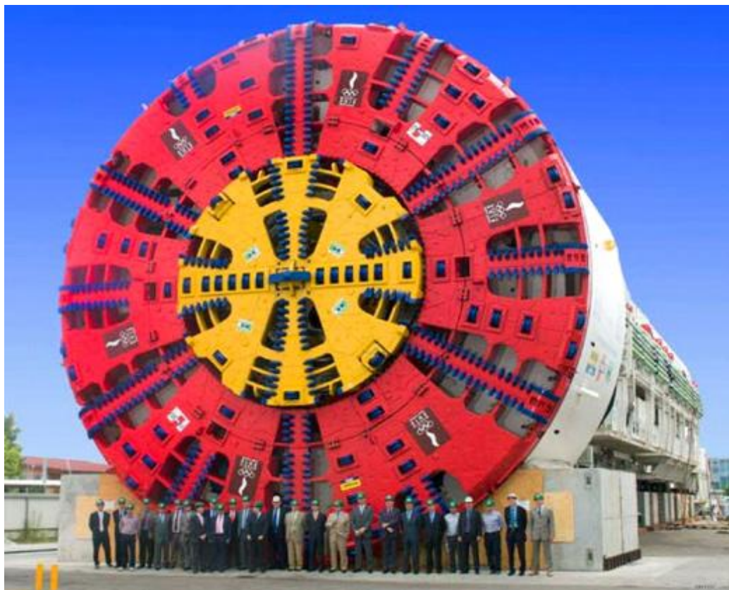
Slika 9: Vrtalni stroj TBM Bertha, širina 17,5 m, teža 7000 ton, izdelana na Japonskem (Vir: http://www.firstpeoplesolutions.co.uk/ )
