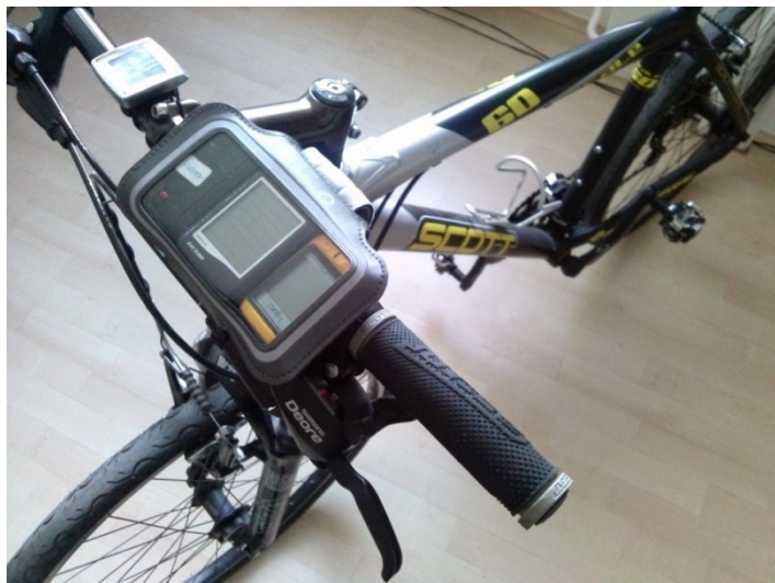
Slika 23: Montiranje ročnih GNSS na krmilo kolesa (lasten prikaz)
