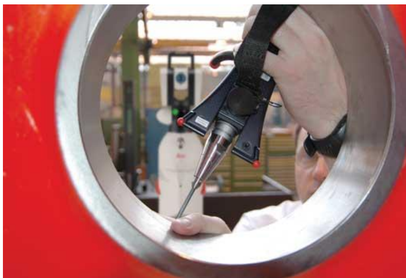
Slika 7.7: Uporaba merilne naprave T-Probe za doseganje težko dostopnih mest komponent letala ( www.leica-geosystems.com )
