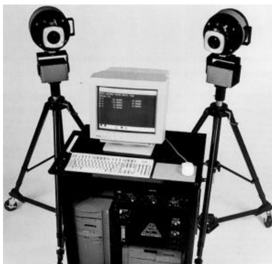
Slika 2.4: Industrijski merilni sistem GSI VSTARS (Luhmann in sod., 2006)
