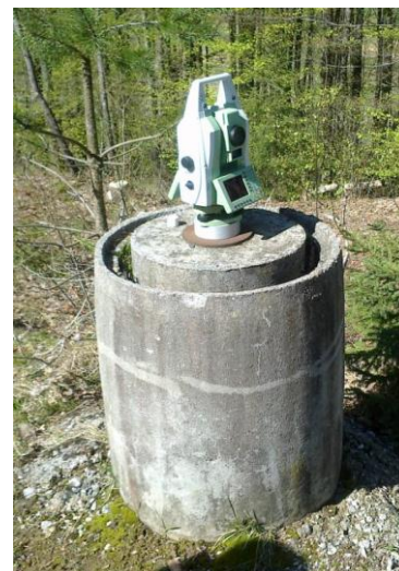
Slika 5: Stabilizacija v geodetski mreži Plaz z uporabo betonskih stebrov ([2], [4])
