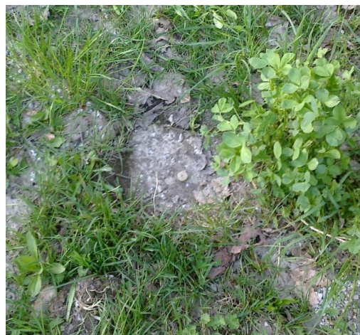
Slika 6: Stabilizacija v geodetski mreži Plaz z uporabo talnih označb ([2], [4])
