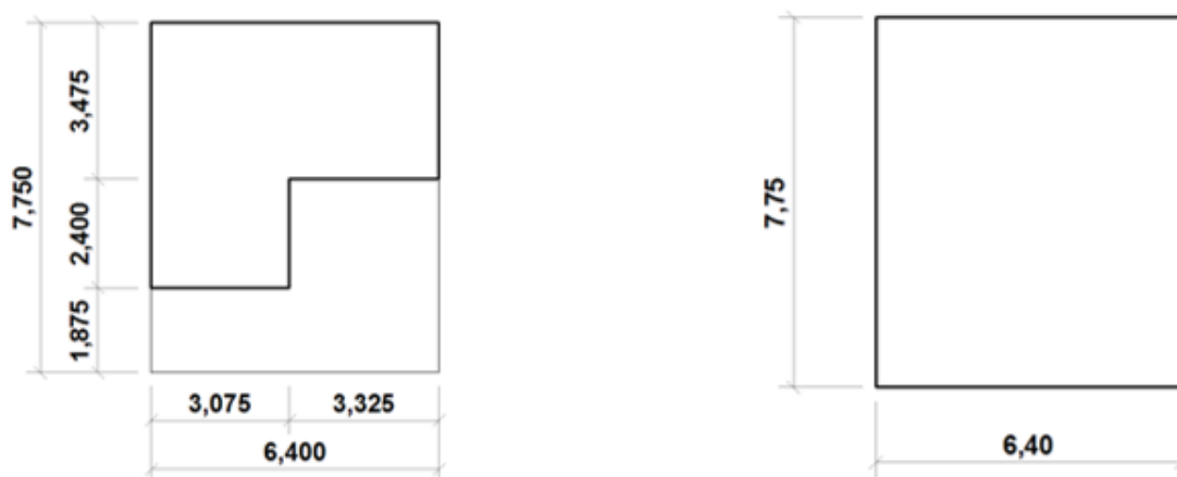
Slika 57: Plošča stopniščnega jedra (POZ202)
