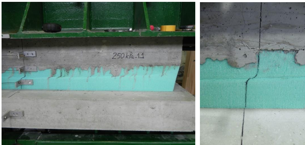
Slika 7: Strižna porušitev materiala pri vertikalni obremenitvi 250 kPa (vir slike: KPMK)
