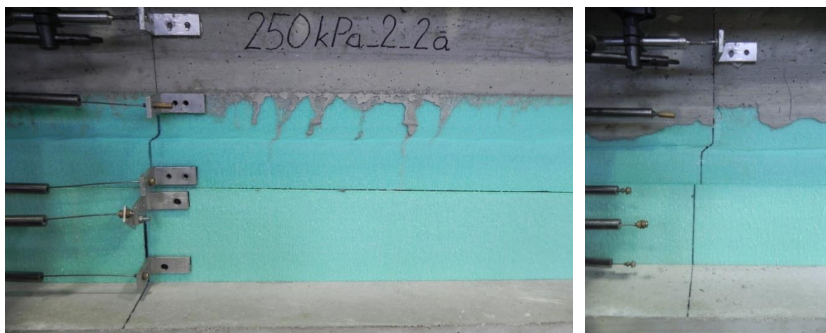
Slika 10: Strižna porušitev preizkušanca pri vertikalni obremenitvi 250 kPa
