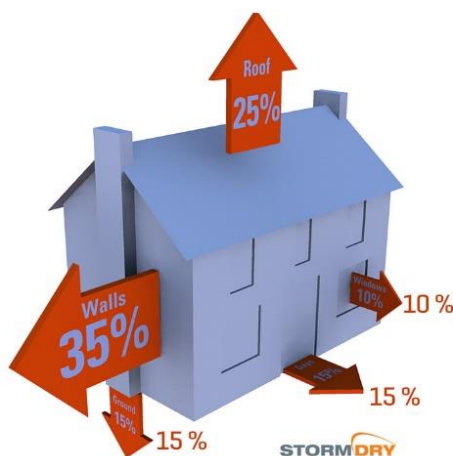
Slika 1: Delež toplotnih izgub skozi stavbni ovoj (Stormdry, 2014)
