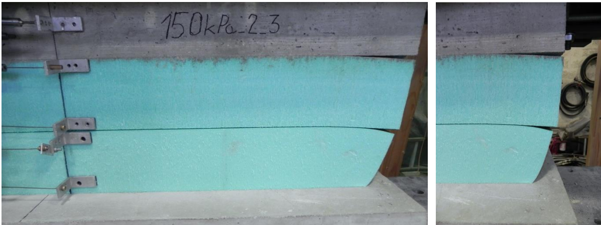
Slika 9: Zdrs preizkušanca pri vertikalni obremenitvi 150 kPa
