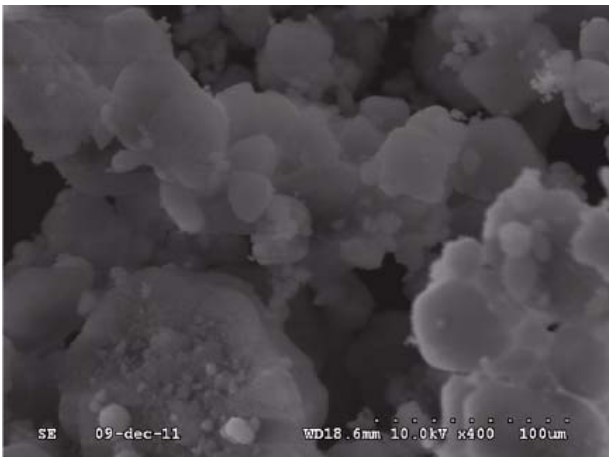
Slika 7: Praškasta silika, posneta s SEM (angl. Scanning Electron Microscope). Oblika delcev fumed silike je sferična, kar vodi do majhnih kontaktov in tako do majhne toplotne prevodnosti. Majhne stične točke se ohranijo tudi v obteženem stanju. [13]
