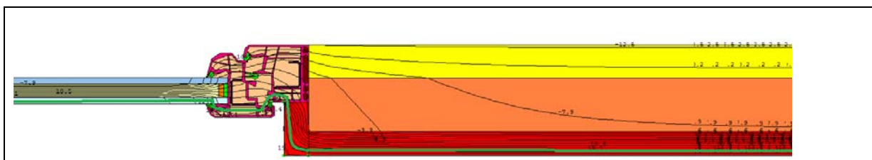
Slika 53: Potek izoterm v tlorisu V-4
