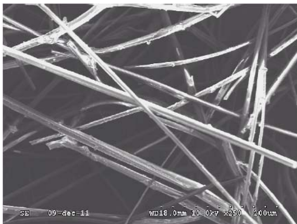
Slika 8: Steklena vlakna, posneta s SEM (angl. Scanning Electron Microscope). Oblika steklenih vlaken je cilindrična, kar pomeni, da so kontakti manjši. Toplotna prevodnost med vlakni je majhna, tudi če so vlakna obtežena. [13]
