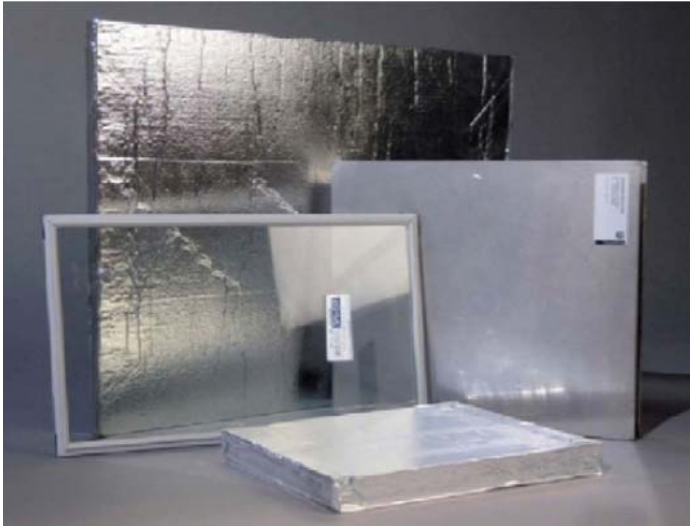
Slika 5: Razlika med vakuumskimi izolacijskimi paneli, vakuumskimi sendvič elementi in vakuumskimi sistemi iz stekla [7]
