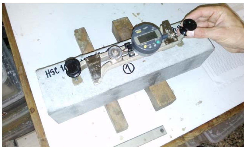
Slika 10: Merjenje celotnega krčenja
