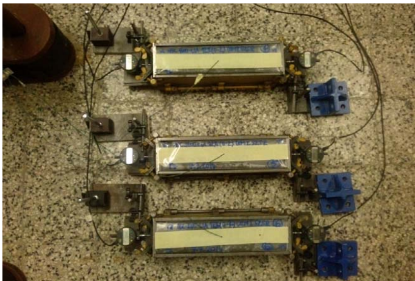
Slika 9: Merjenje Krčenja zatesnjenih preizkušancev
