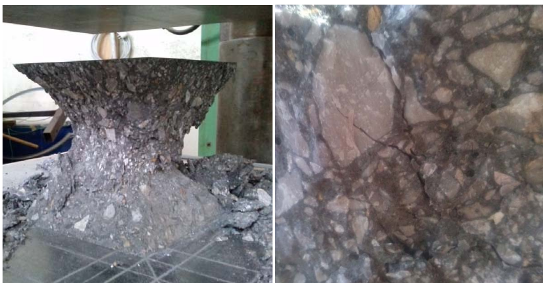
Slika 8: Porušitev betonskega preizkušanca ob preizkušanju enoosne tlačne trdnosti
