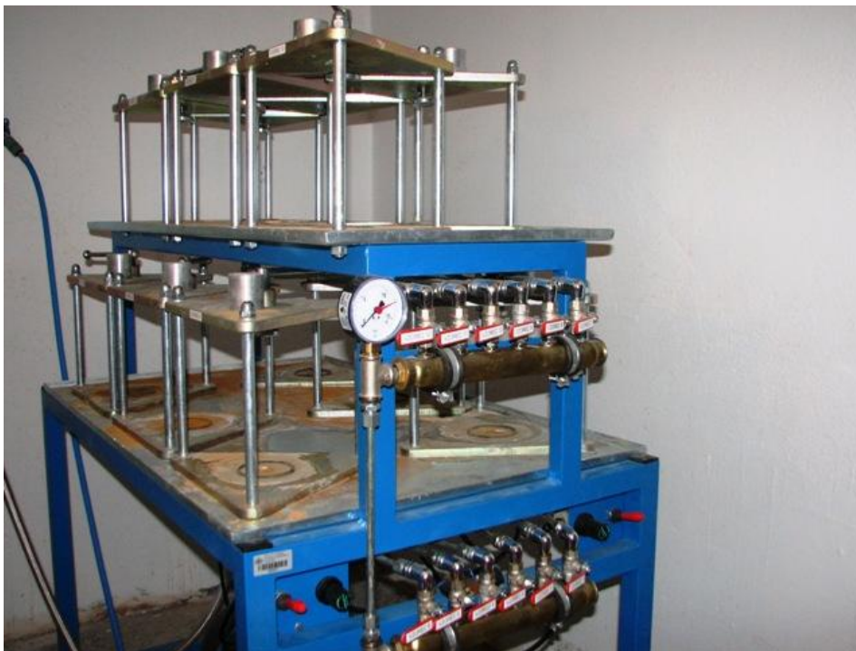
Slika 20: Naprava za preizkus vodotesnosti
