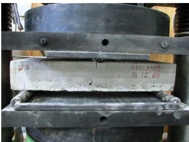
Slika 32: Upogibna obremenitev plošče iz katere smo izvrtali valje
