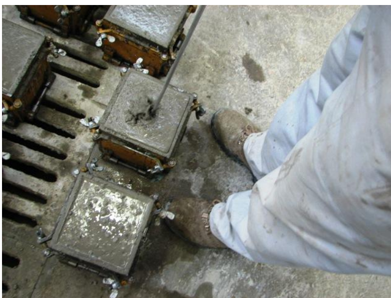
Slika 28: Vpihovanje zraka za nastanek zračnih žepov
