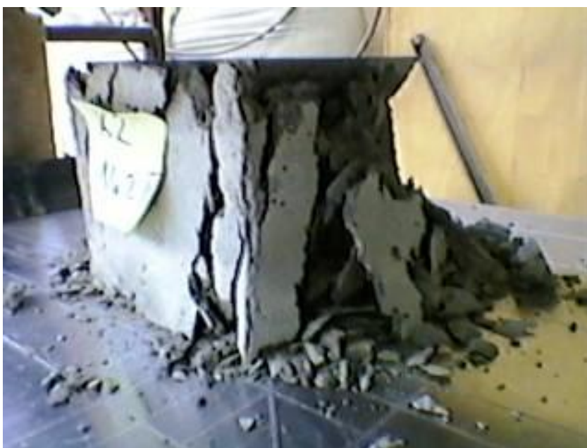
Slika 16: Primer tlačnega preizkusa kocke
