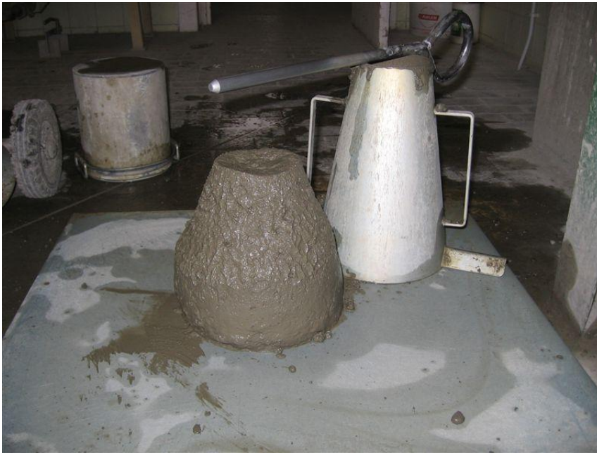
Slika 9: Kovinski konus in poseden betonski vzorec.
