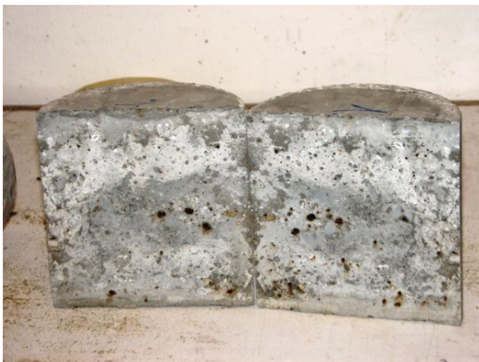
Slika 26: Primer razklanega valja po površini hladnega stika
