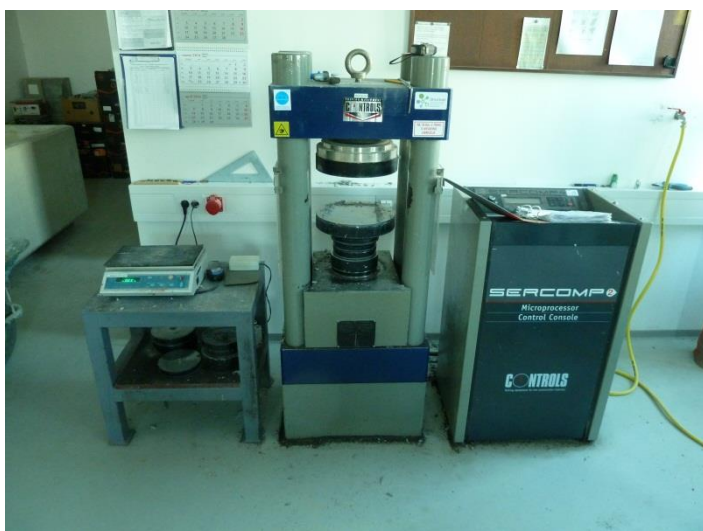
Slika 10: Hidravlična stiskalnica za ugotavljanje tlačne trdnosti
