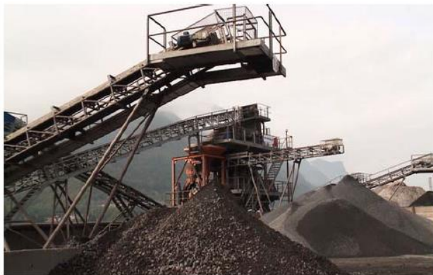
Slika 7: Mehanska obdelava žindre (vir: [1])
