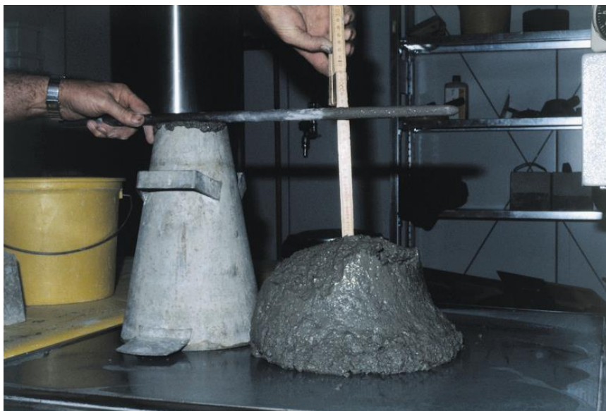
Slika 5.2.2.2.a: Meritev poseda betona.
