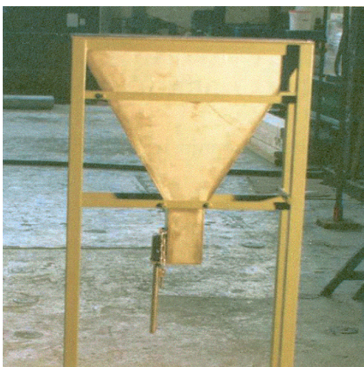
Slika 5.2.1.2.a: V-lijak za preiskavo viskoznosti na FGG
