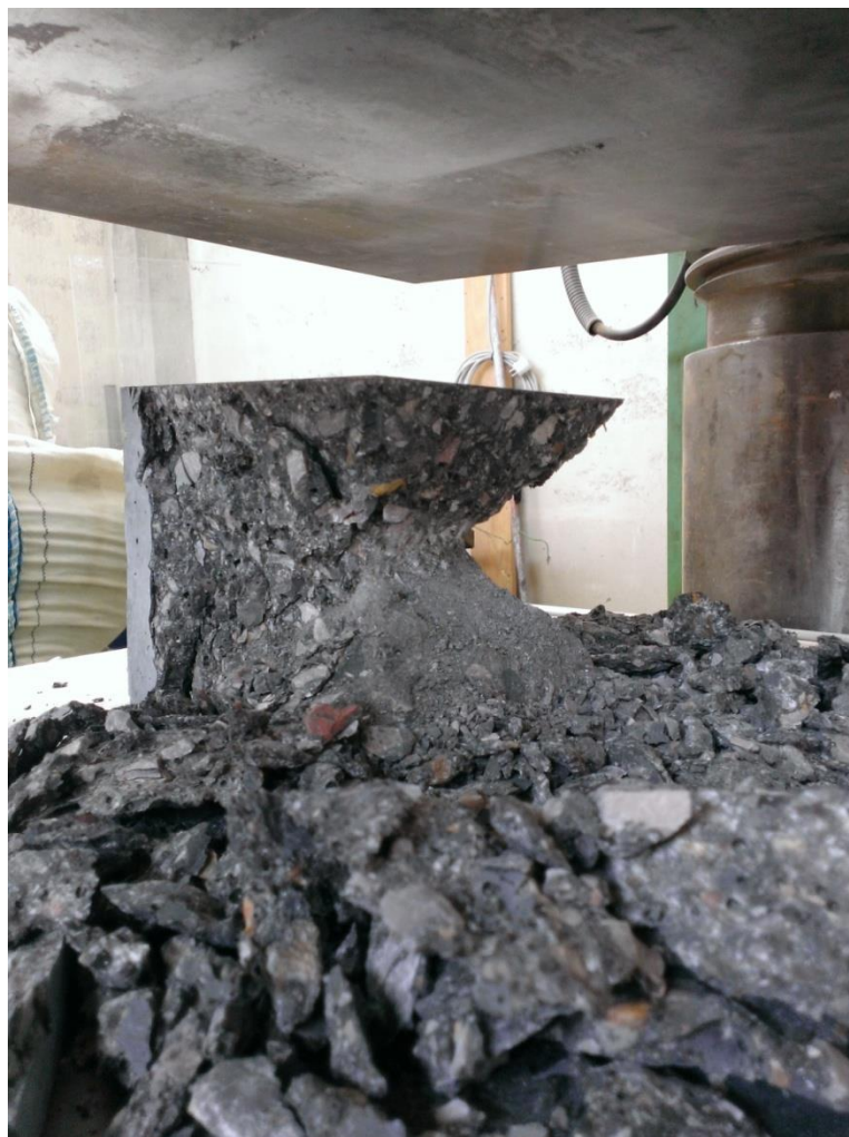
Slika 19: Vzorec porušen z elektromehaničnim preizkuševalnim strojem.
