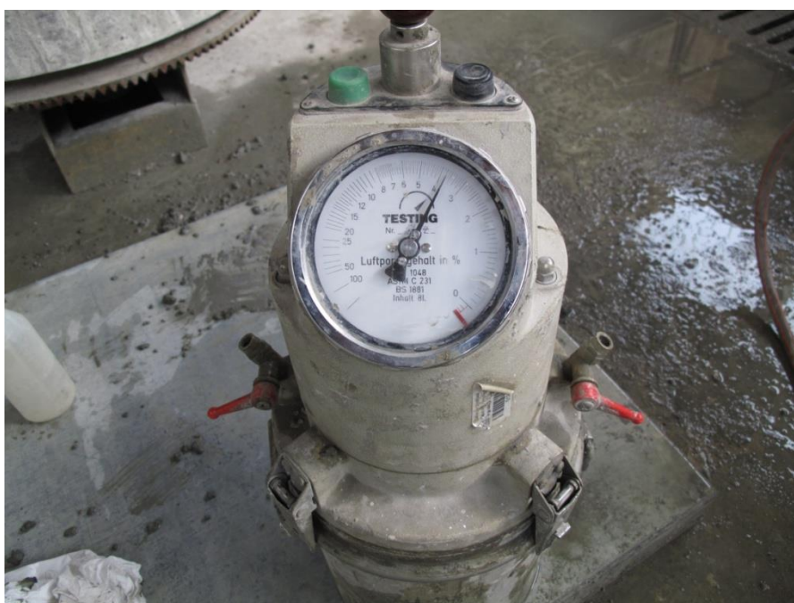
Slika 18: Posoda z manometrom za merjenje vsebnosti por v svežem betonu.
