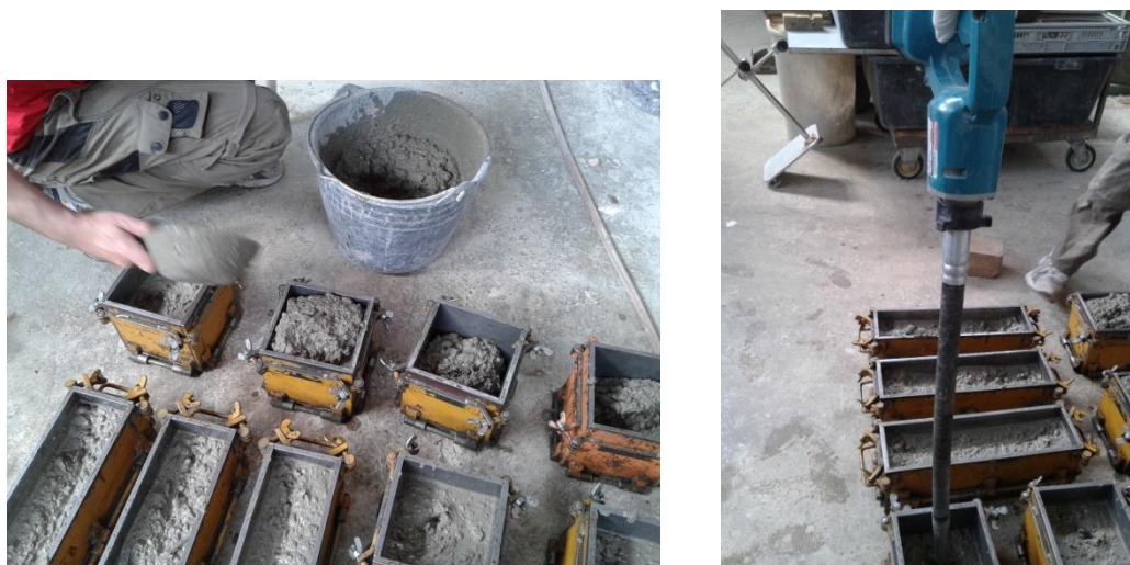
Slika 26: Polnjenje kalupov (levo) in vibriranje betonske mešanice (desno)
