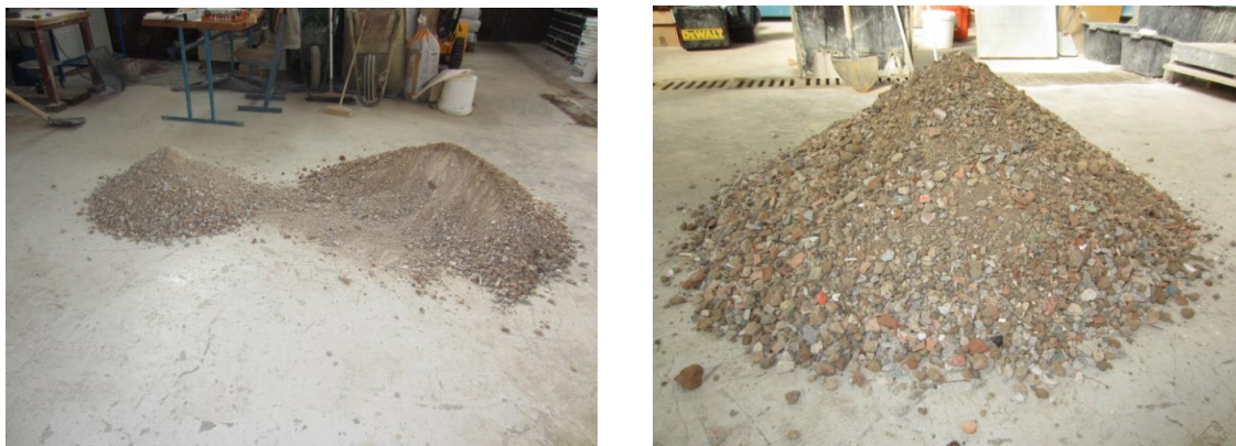
Slika 7: Kup med mešanjem (levo) in premešan kup materiala (desno)
