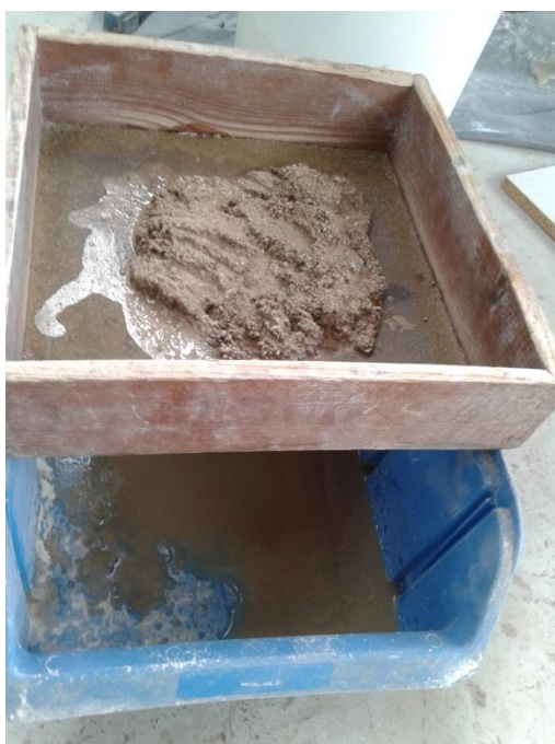
Slika 18: Odcejanje vode in kohezija materiala (levo) in oblikovanje kupčka (desno)
