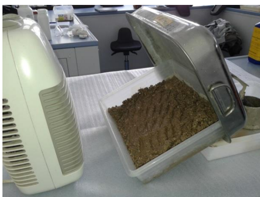
Slika 19: Sušenje vzorca (levo) in kup, ki je še premoker in ima zato nepravilno obliko (desno)
