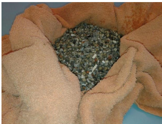
Slika 17: Agregat na cedilu (levo) in površinsko suh agregat (desno)
