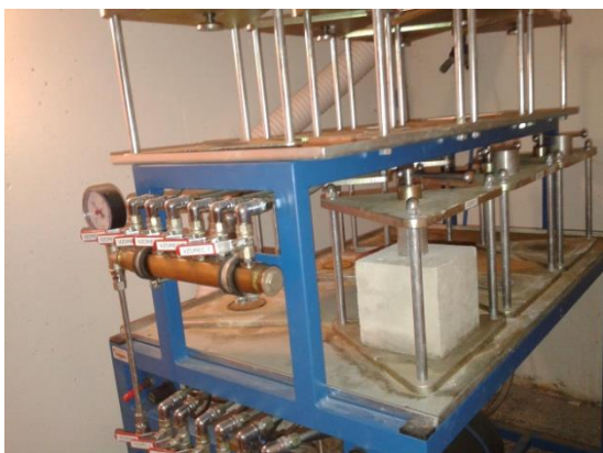
Slika 30: Preizkušavec v napravi (levo) in označena globina prodora vode na razcepljeni kocki (desno)
