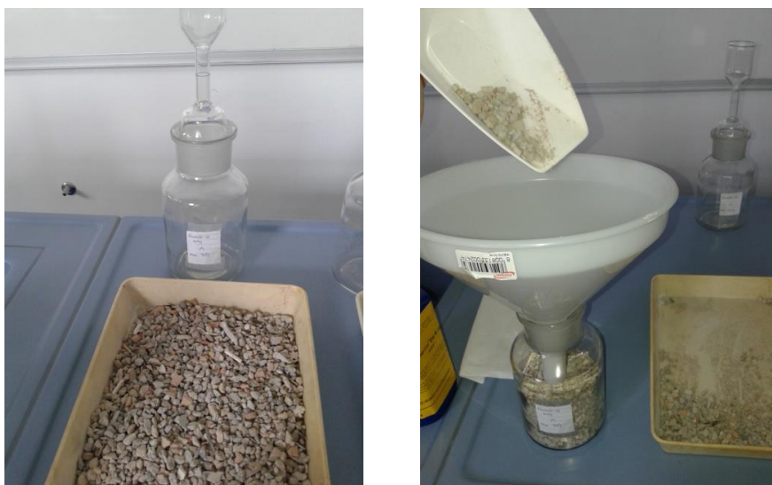
Slika 14: Pred začetkom preiskave s piknometrom (levo) in polnjenje piknometra z agregatom (desno)
