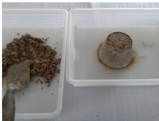
Slika 18: Odcejanje vode in kohezija materiala (levo) in oblikovanje kupčka (desno)
