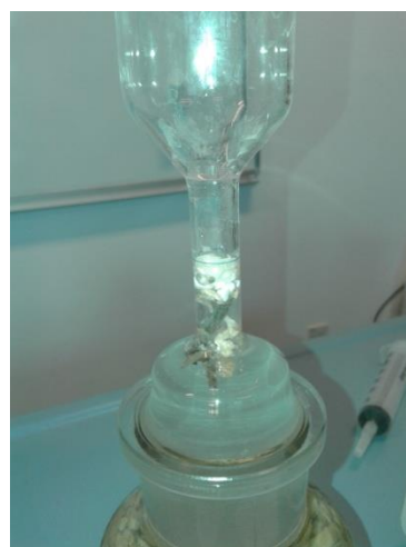
Slika 16: Znižana gladina vode zaradi vpivanja vode po 24 urah (levo) in ponovno dodana voda do oznake (desno)
