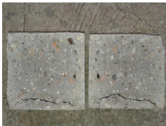
Slika 30: Preizkušavec v napravi (levo) in označena globina prodora vode na razcepljeni kocki (desno)
