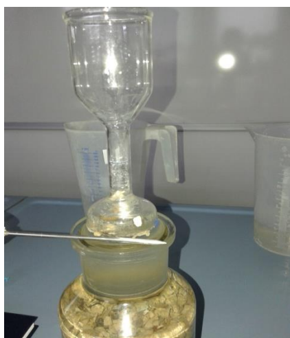
Slika 16: Znižana gladina vode zaradi vpivanja vode po 24 urah (levo) in ponovno dodana voda do oznake (desno)
