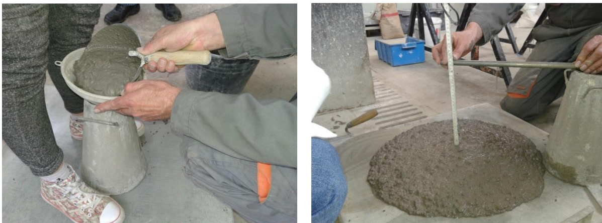
Slika 22: Konus med polnjenjem (levo) in merjenje spremembe višine zaradi poseda (desno)
