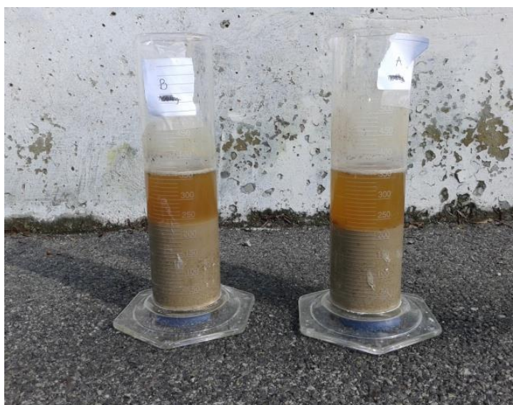
Slika 13: Rezultat preiskave vsebnosti humoznih delcev po 24 urah
