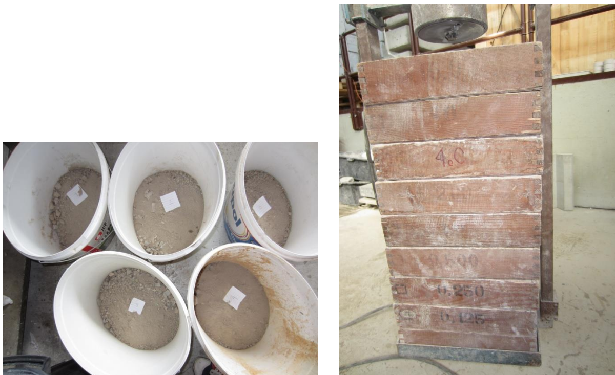
Slika 8: Pripravljene vzorce za sejanje (levo) in sita za sejanje (desno)
