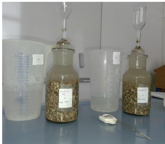
Slika 15: Tehtanje piknometra in agregata (levo) in piknometer, agregat in voda do oznake (desno)
