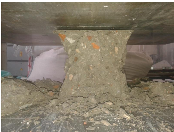
Slika 28: Po standardu SIST EN 12390-3 je takšna porušitev zadovoljiva
