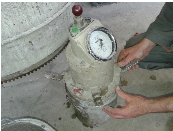
Slika 25: Določanje vsebnosti zraka v svežem betonu
