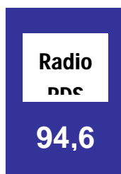
slika 34: znak, ki nas obvešča o radijski frekvenci, ki jo lahko spremljamo skozi predor in posreduje aktualne prometne podatke o stanju na cesti, v predoru
