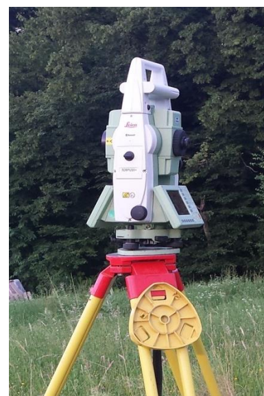
Slika 7: tahimeter Leica TCRP 1201+R1000 (Šeme, 2014)
