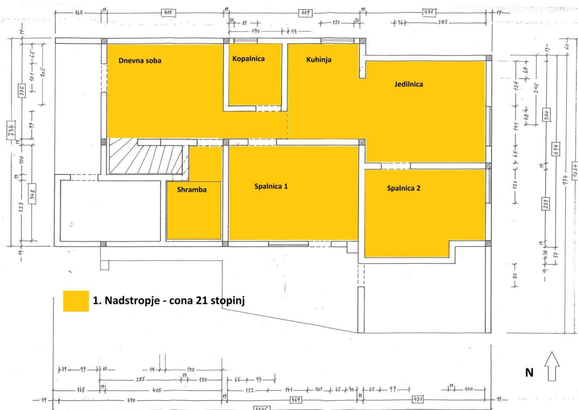
Slika 6: Razdelitev 1. nadstropja na cone ogrevanja [10]
