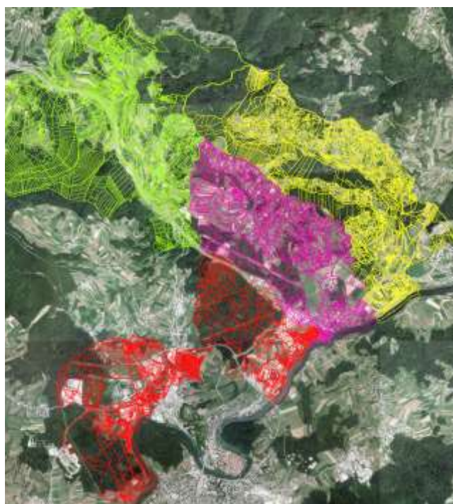
Slika 11: Prikaz katastrskih načrtov skupine sosednjih katastrskih občin po zaključni homogenizaciji katastrske meje k.o. Ždinja vas (Vir: lasten prikaz)
