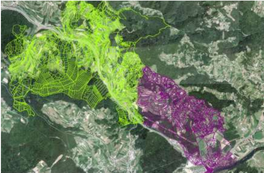
Slika 17: Prikaz katastrskih načrtov, transformiranih s Helmertovo transformacijo, za k.o. Ždinja vas (vijolična) in k.o. Zagorica (zelena) (Vir: lasten prikaz)
