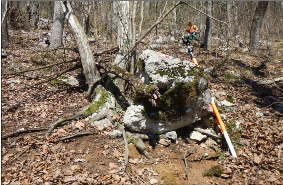
Slika 7: Primer nevarne skale slabše stabilnosti velikosti prib. 1,2 m 2 (Vir: Aljaž Peklaj)
