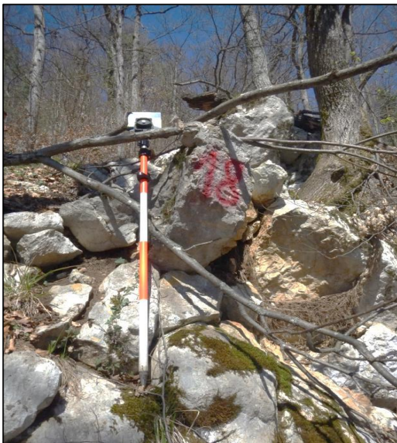
Slika 8: Primer nevarne skale slabše stabilnosti, potreben je takojšen ukrep (Vir: Aljaž Peklaj)
