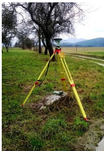
Slika 10: Postavitev antene Leica Viva nad točko POLI2
