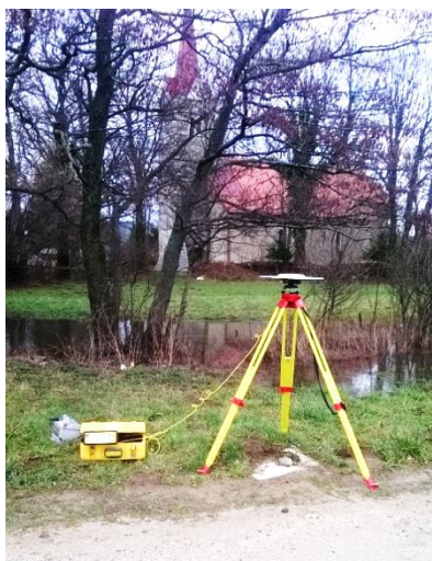
Slika 11: Postavitev antene Trimble nad točko TRIG
