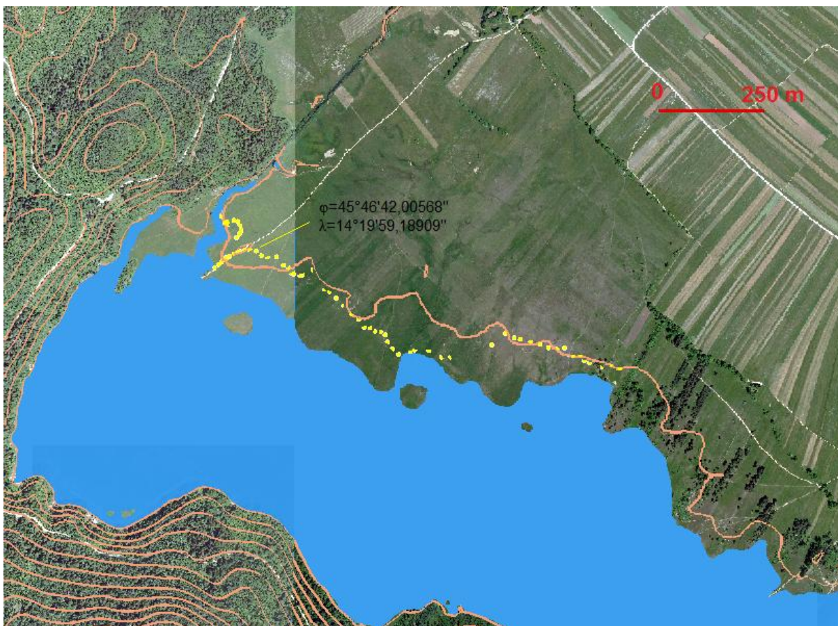
Slika 14: Prikaz vodostaja na Cerknjškem jezuru dne 17.1.2014 skupaj z merjenimi diskretnimi točkami (DOF050 v novem koordinatnem sistemu D96/TM, DMV 5)
