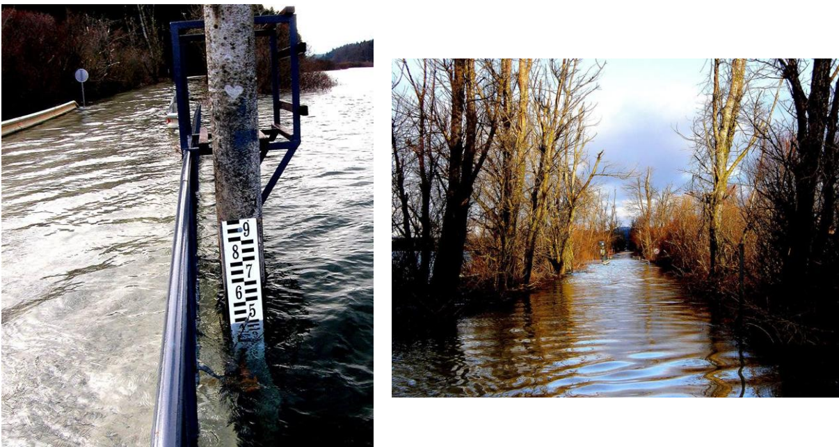
Slika 16: Merilno mesto vodostaja na mostu (levo) ter pogled na poplavljen most in makadamsko pot Dolenje Jezero-Otok (desno) (Foto: Gornik M.)
