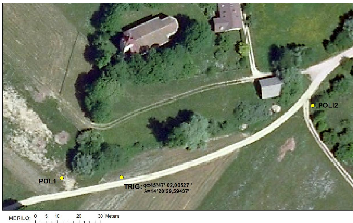
Slika 8: Statična metoda izmere na terenu (DOF050 v novem koordinatnem sistemu D96/TM)
