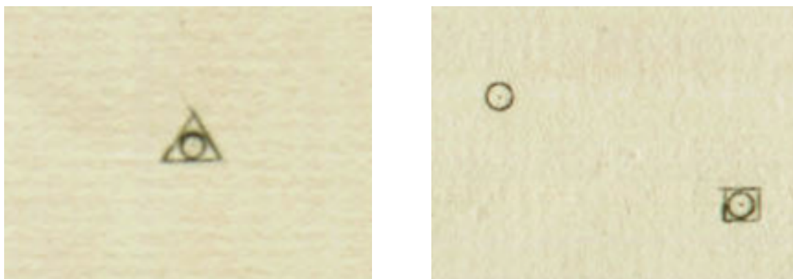
Slika 19: Izrezi iz katastrskih načrtov, na katerih so prikazane različne vrste triangulacijskih točk (Vir: ARS, 2014).
