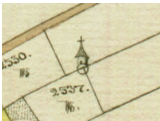
Slika 20: Izrezi iz katastrskih načrtov, na katerih so označene različne vrste trianguacijskih točk, z dodatnim simbolom (Vir: ARS, 2014).
