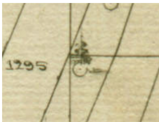
Slika 20: Izrezi iz katastrskih načrtov, na katerih so označene različne vrste trianguacijskih točk, z dodatnim simbolom (Vir: ARS, 2014).
