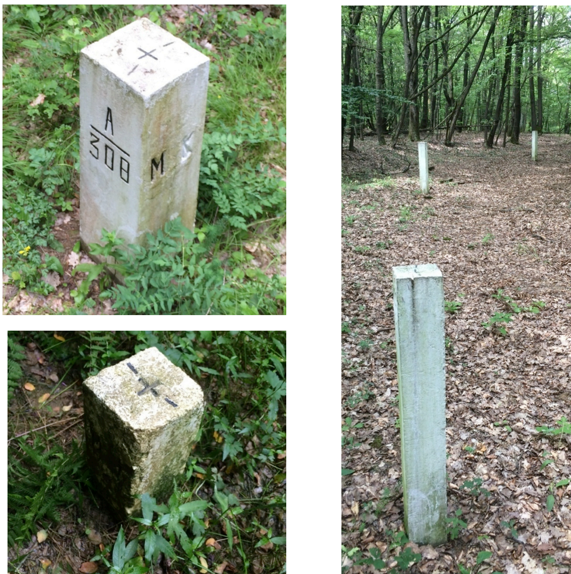
Slika 24: Na zgornji levi sliki je primer glavnega mejnega znaka, na spodnji levi sliki je primer druge vrste vmesnega mejnega znaka in na desni sliki je primer prve vrste vmesnega mejnega znaka.
