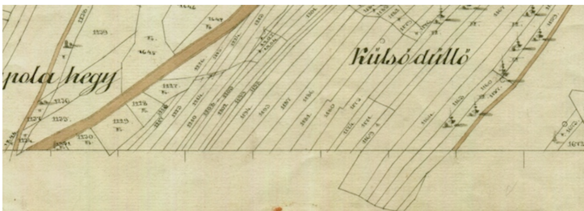
Slika 23: Izrez iz katastrskega načrta, na katerem so prikazane parcele, ki so narisane tudi izven okvira. Prikazana je tudi palčna razdelba na okviru načrta (Vir: ARS, 2014).
