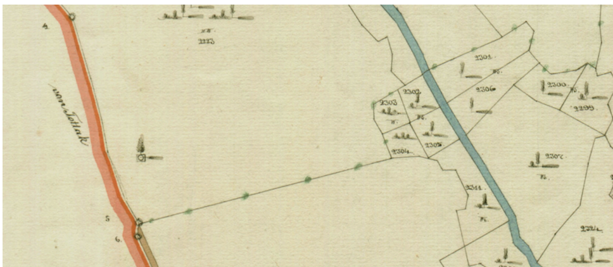
Slika 22: Izrez katastrskega načrta, na katerem je prikazan potek meje katastrske občine. Na sliki lahko opazimo tudi črto z zelenimi pikami (Vir: ARS, 2014).
