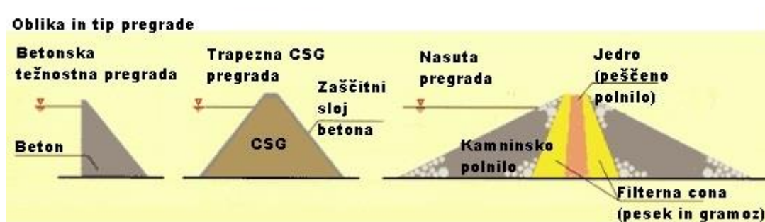
Slika 14 Primerjava med betonsko pregrado, pregrado iz stabilizirane zemljine in nasuto zemeljsko pregrado s tesnilnim jedrom [11]
