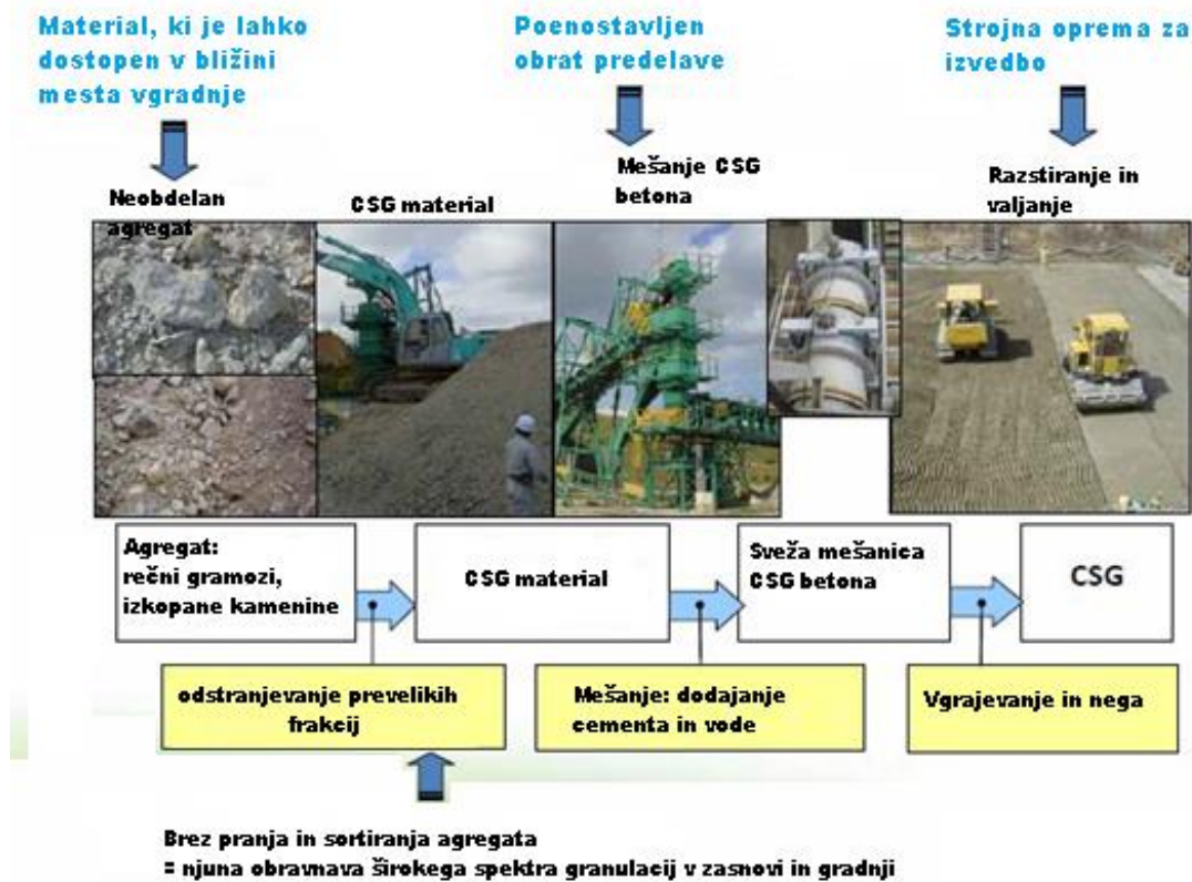
Slika 16: Pridobivanje in proizvodnja CSG materiala [8]
