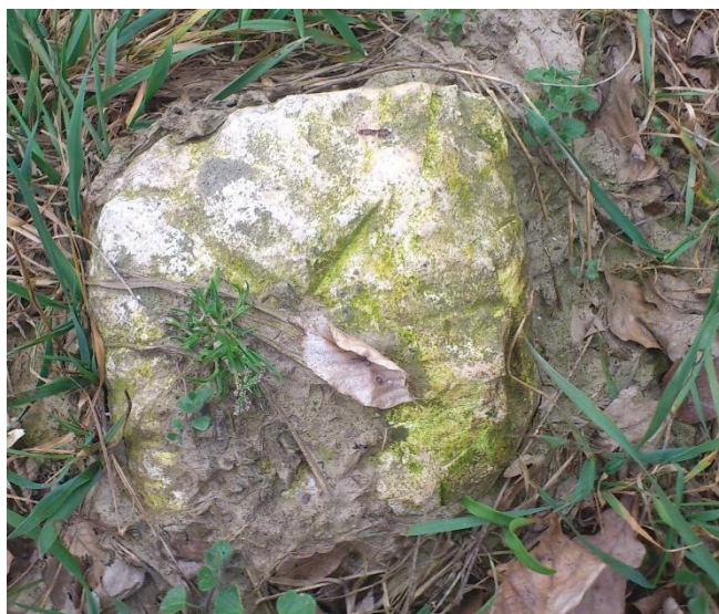
Slika 10: Stabilizacija trigonometrične točke – točka RAZ1
