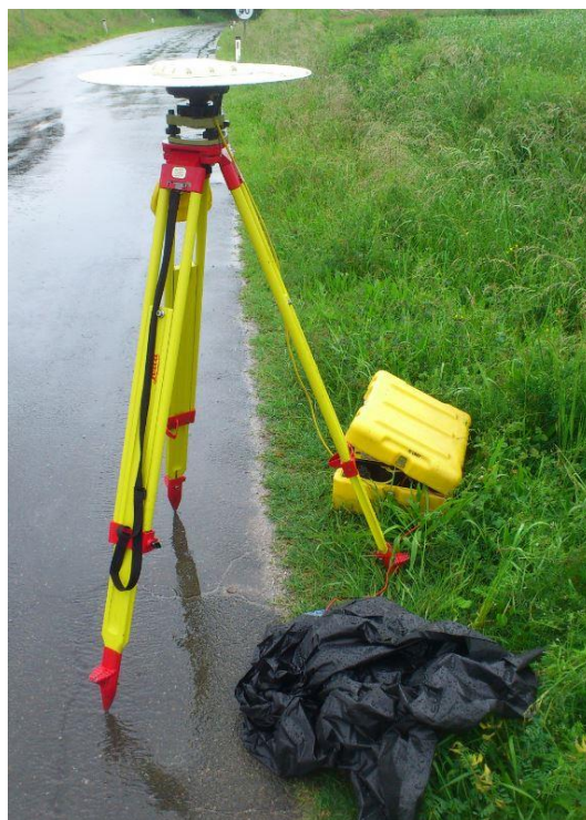
Slika 15: Postavitev antene nad poligonsko točko pri hitri statični izmeri – točka 6000
