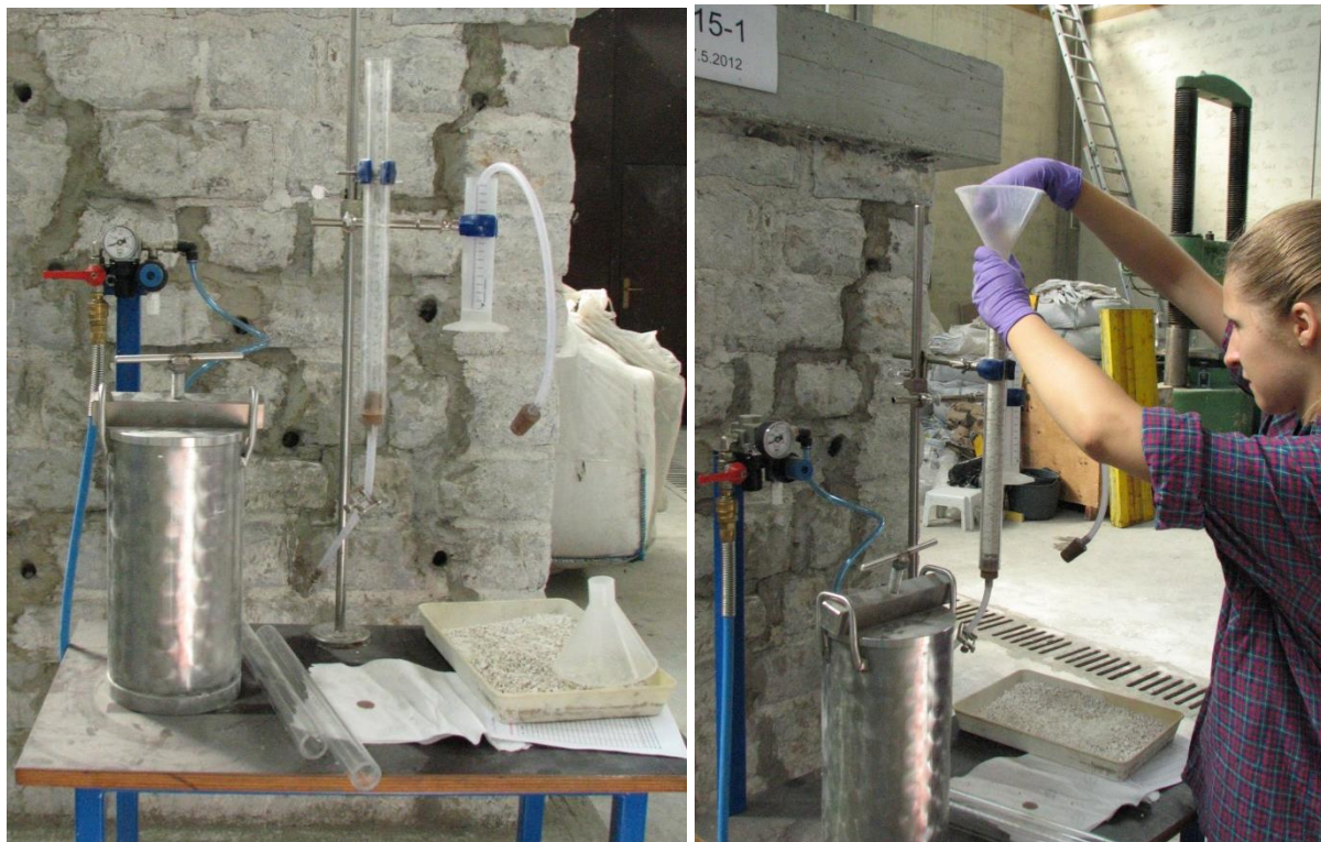
Slika 23: Naprava za injektiranje in testiranje sposobnosti injektiranja
