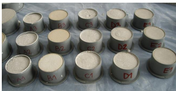
Slika 10: Vzorci v cilindričnih kalupih
