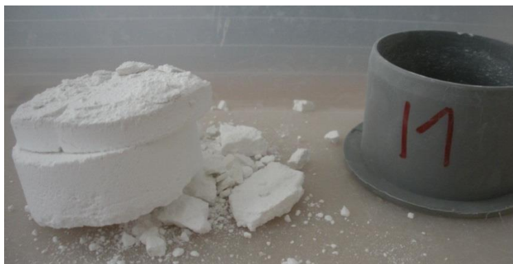
Slika 15: Strjena mešanica I1 po odstranitvi iz kalupa
