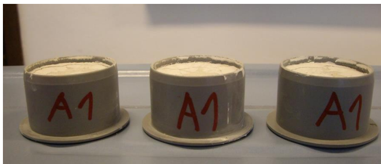
Slika 20: Strjeni vzorci mešanice A1 v plastičnih cilindričnih kalupih
