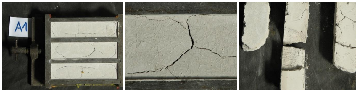
Slika 21: Vzorci mešanice A1 pred in po razkalupljenju
