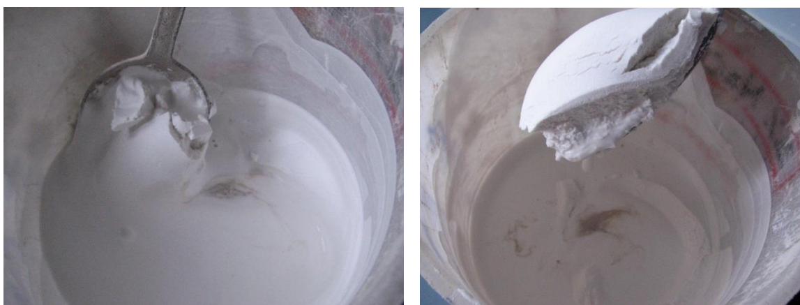
Slika 13: Strjevanje izločenih steklenih kroglic na površini mešanice
