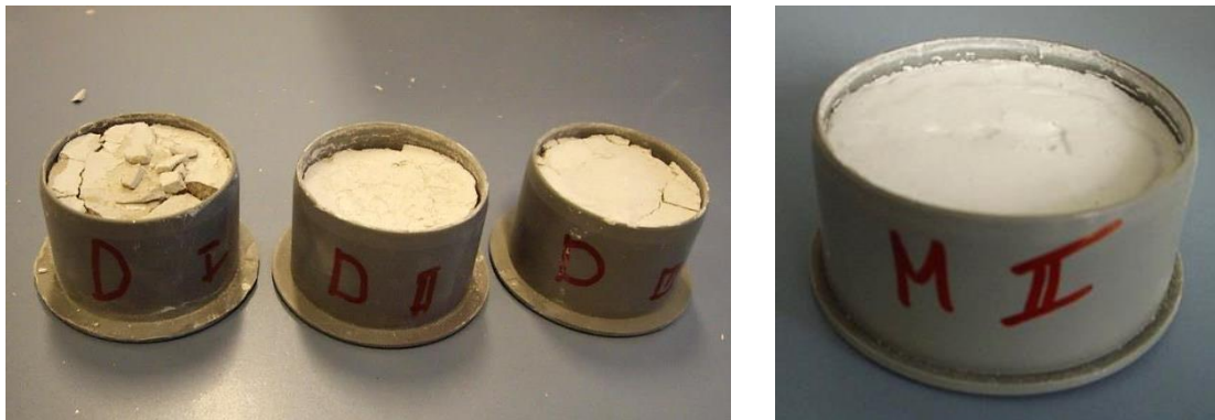
Slika 12: Mešanice D in M po sušenju v cilindričnih kalupih
