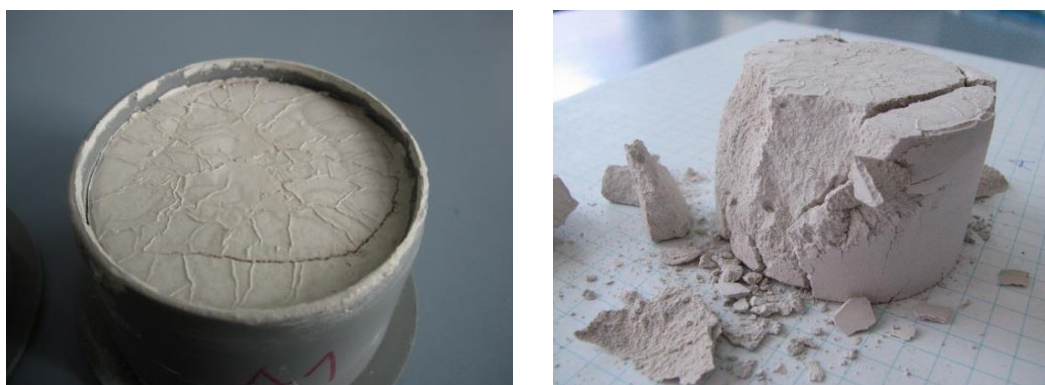
Slika 11: Strjena mešanica A v cilindričnem kalupu ter po odstranitvi iz njega
