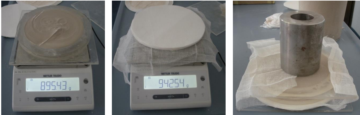
Slika 6: Postopek merjenja vodozadržnosti: tehtanje mase v kalupu; tehtanje mase s kalupom, gazo in filter papirjem; obtežen kalup z maso
