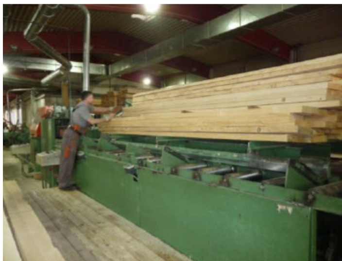
Vizualno določanje kvalitete lamel pred izrezom napak in dolžinskim spajanjem (Andoljšek, 2010)
