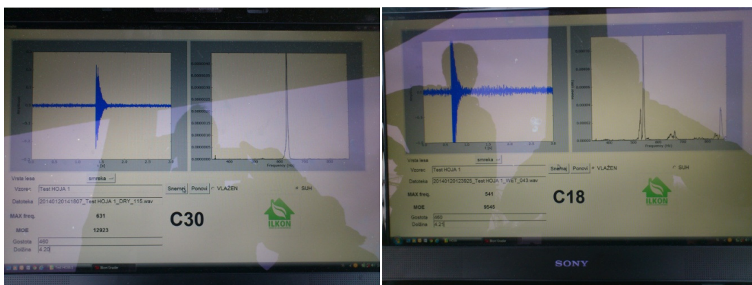
Slika 3.5: Primer jasnega (levo) in motenega odčitka (desno)
