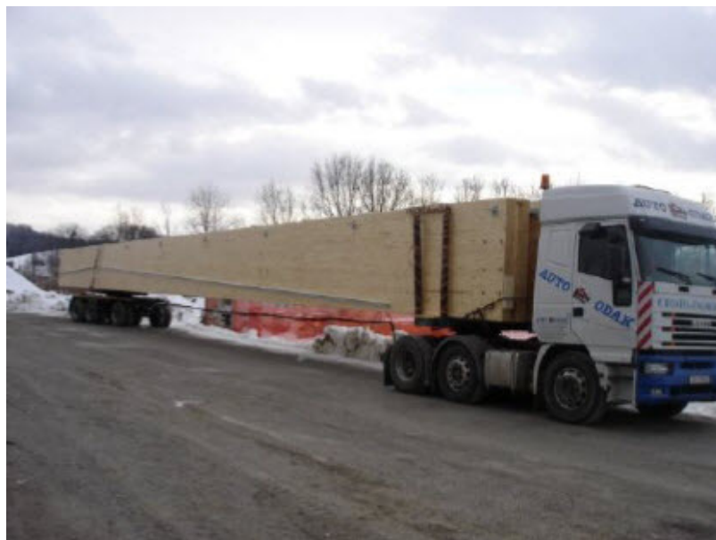
Izredni prevoz lepljenega nosilca na gradbišče (Andoljšek, 2010)
