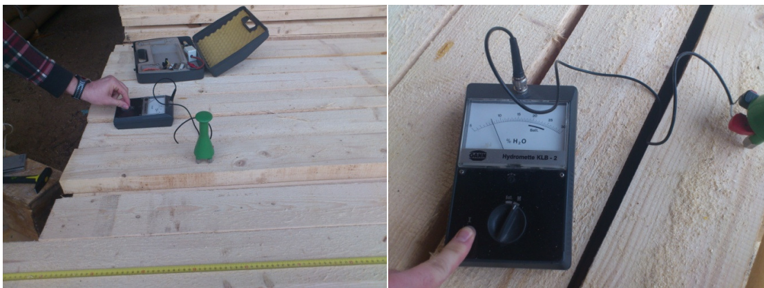
Slika 3.4: Merjenje vlažnosti preizkušancev
