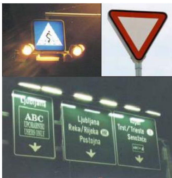
Slika 8: Osvetlitev prometnih znakov in tabel od znotraj in od zunaj
