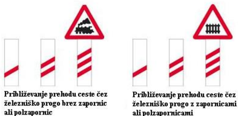
Slika 11: Znak približevanje prehodu ceste čez železniško progo
