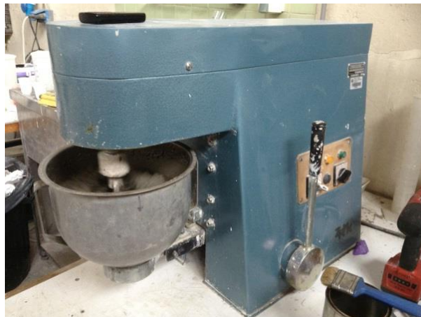
Slika 3: Priprava betonske mešanice
