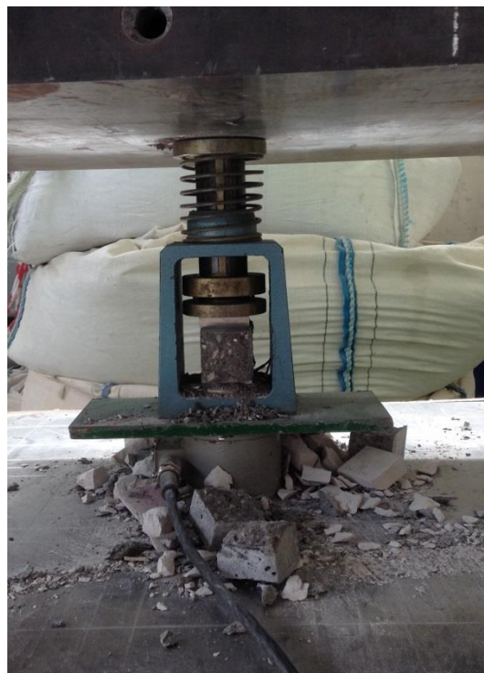
Slika 4: Preizkus tlačne trdnosti betonov
