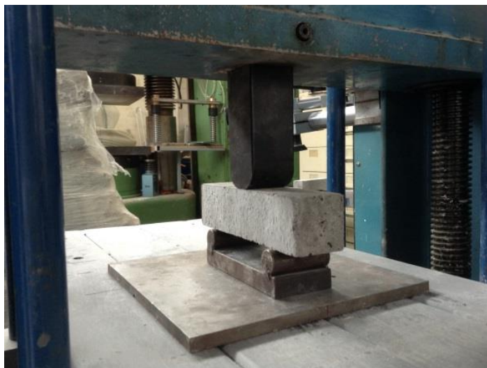
Slika 5: Preizkus upogibne trdnosti betonov
