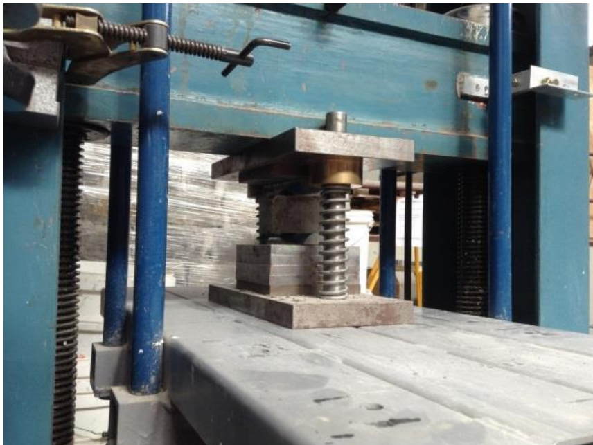
Slika 6: Preizkus cepilne trdnosti betonov
