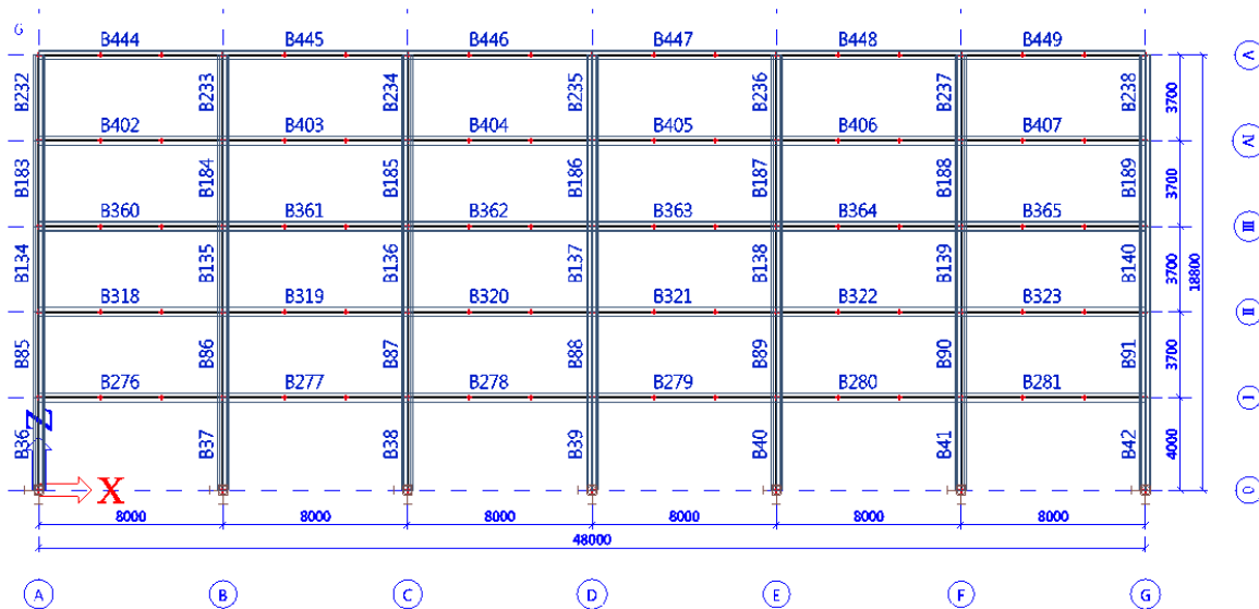
Slika 56: Zasnova prostorskega okvirja 6 – 6, statična analiza
