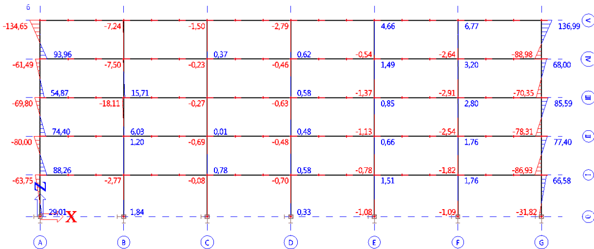
Slika 89: Upogibni momenti M_y [kNm]; prostorski okvir 6 – 6, potres_gravitacijski, MSN1
