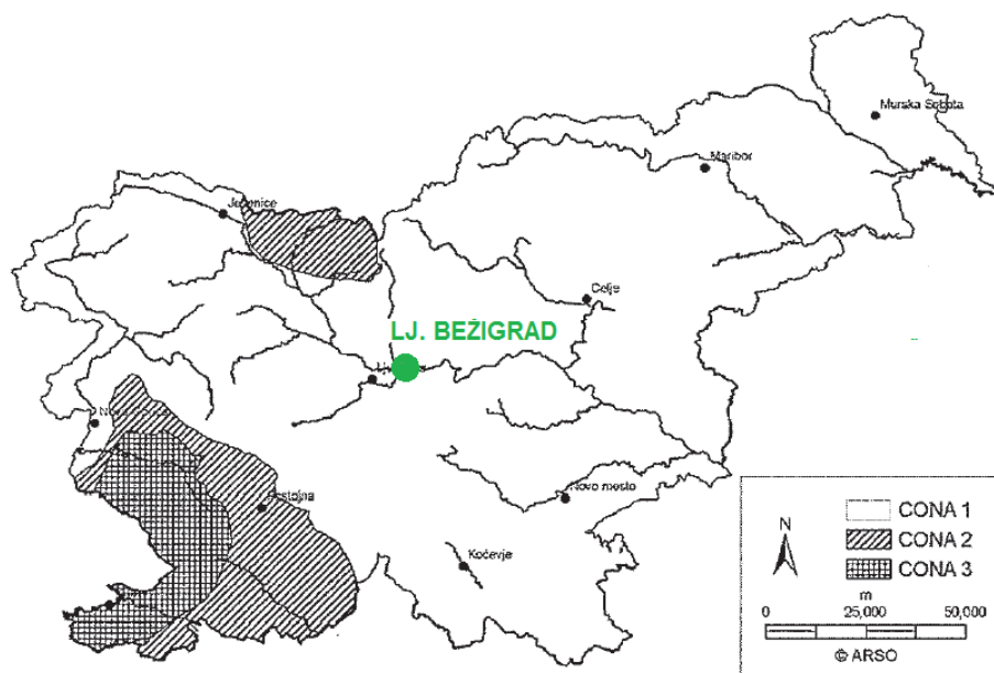
Slika 13: Temeljna vrednost osnovne hitrosti vetra v_{b,0} (SIST EN 1991-1-4:2005/A101:2008. str.5)
