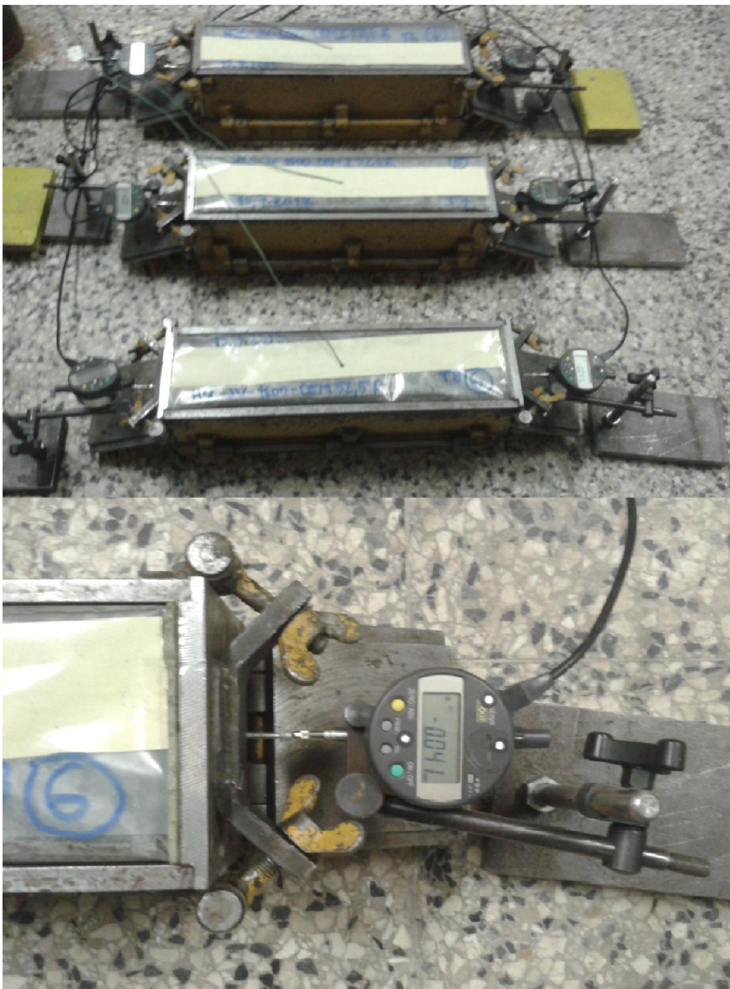
Slika 11: Elektronsko merjenje zgodnjega avtogenega krčenja betona
