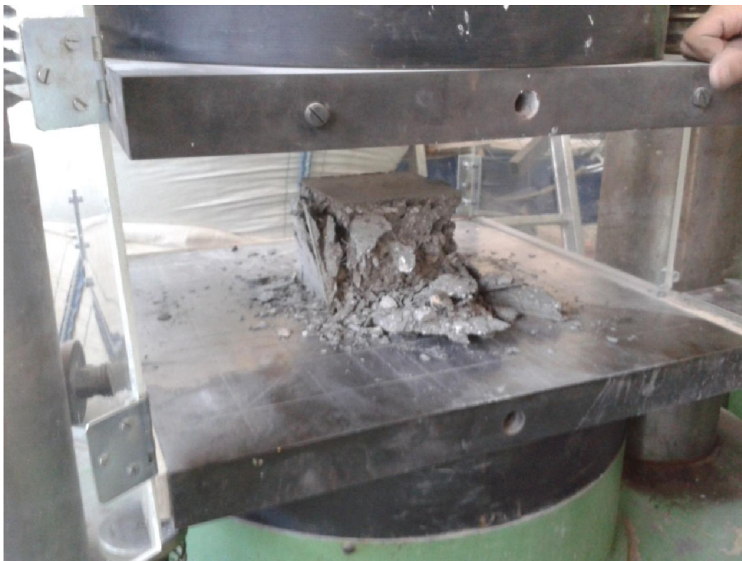
Slika 9: Porušena betonska kocka po enoosnem tlačnem preizkusu
