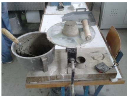
Slika 3: Vgrajevanje betona v prisekan stožec (levo) in meritev dveh diagonal razleza (desno)
