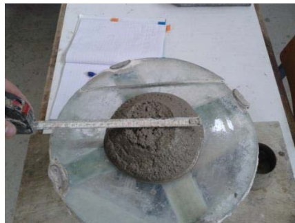
Slika 3: Vgrajevanje betona v prisekan stožec (levo) in meritev dveh diagonal razleza (desno)
