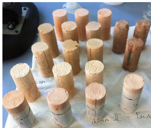
Slika 15: Obarvana površina preizkušancev
