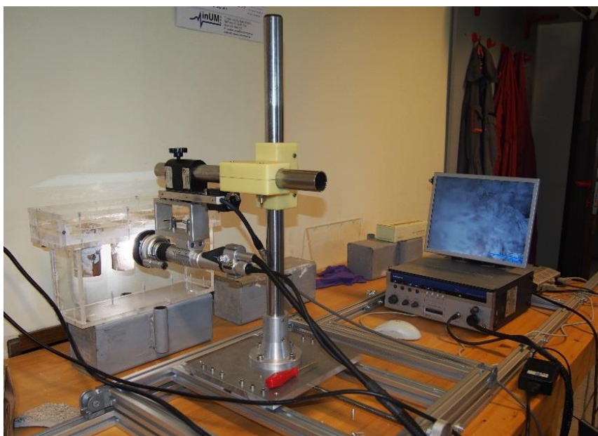
Slika 26: Mikroskopiranje s 3D optičnim mikroskopom
