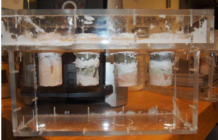
Slika 25: Preizkušanci izpostavljeni močenju z vodno raztopino soli v 2. komori
