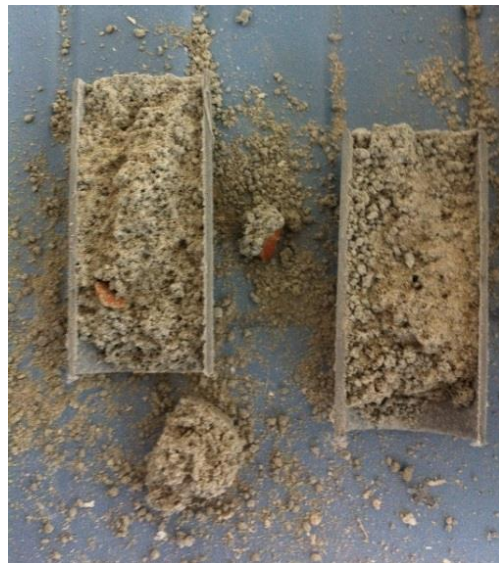
Slika 14: Neuspešen poskus odstranitve kalupa
