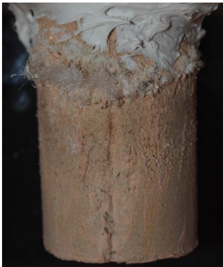
Slika 40: Preizkušanec št. 4 - kristali v obliki tankih iglic
