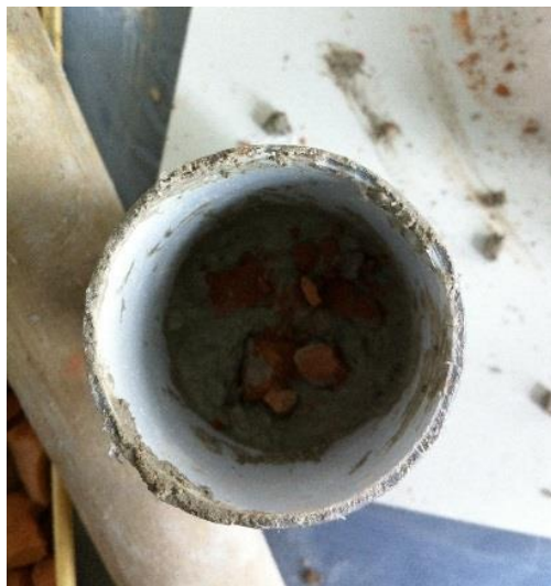
Slika 8: Koščki opeke v mešanici apneno-cementne malte
