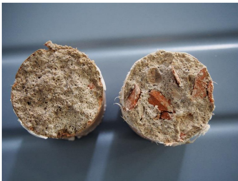
Slika 41: Prelomljen preizkušanec; brez poškodb v notranjosti zaradi kristalizacije
