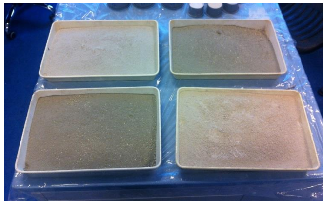
Slika 9: Vzorci suhe mešanice ometov, ki se med seboj razlikujejo po sestavi
