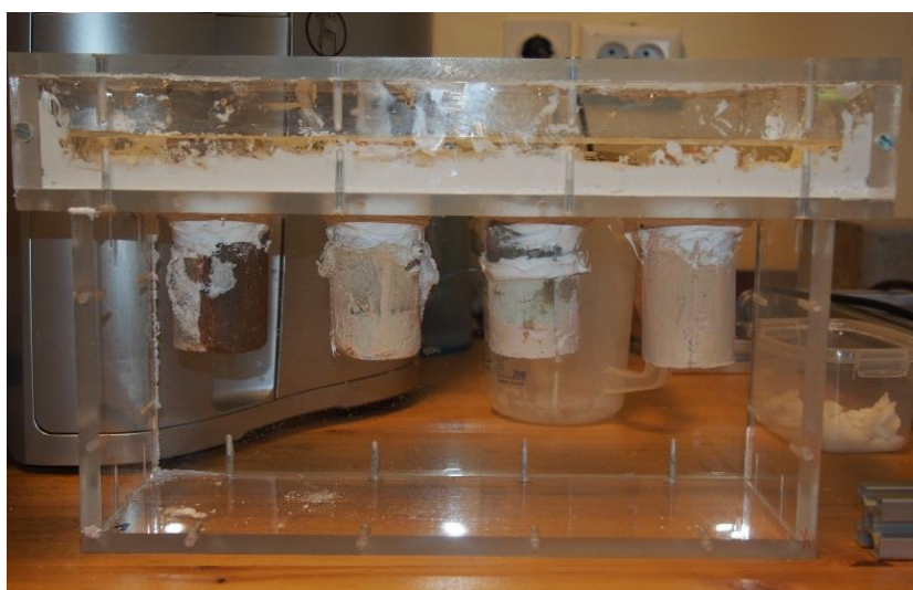
Slika 24: Preizkušanci izpostavljeni močenju z vodno raztopino soli v 1. komori
