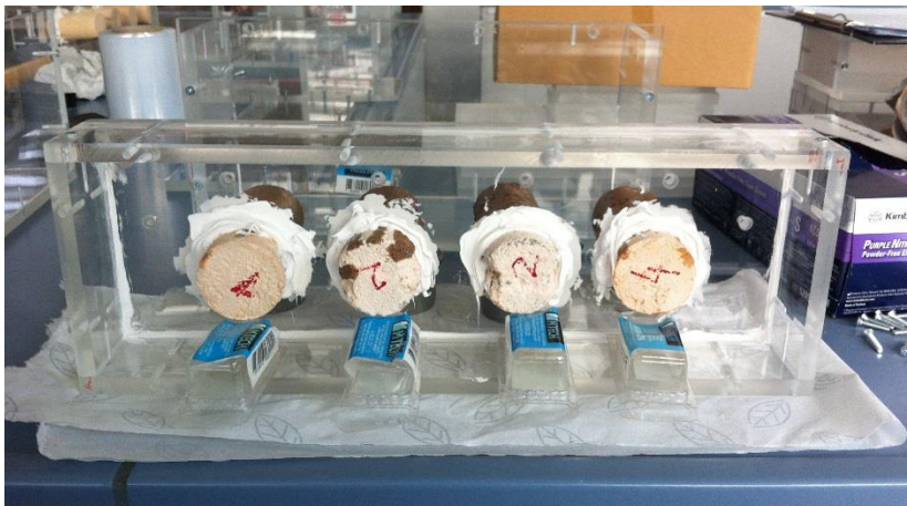
Slika 17: Vgradnja preizkušancev in sušenje silikona
