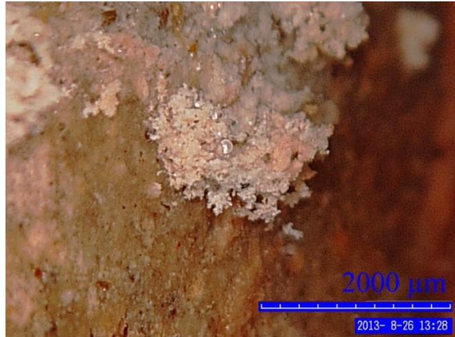
Slika 38: Preizkušanec št. 2 po raztapljanju kristalov soli
