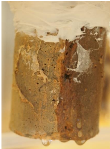
Slika 37: Preizkušanec št. 1 po raztapljanju kristalov soli
