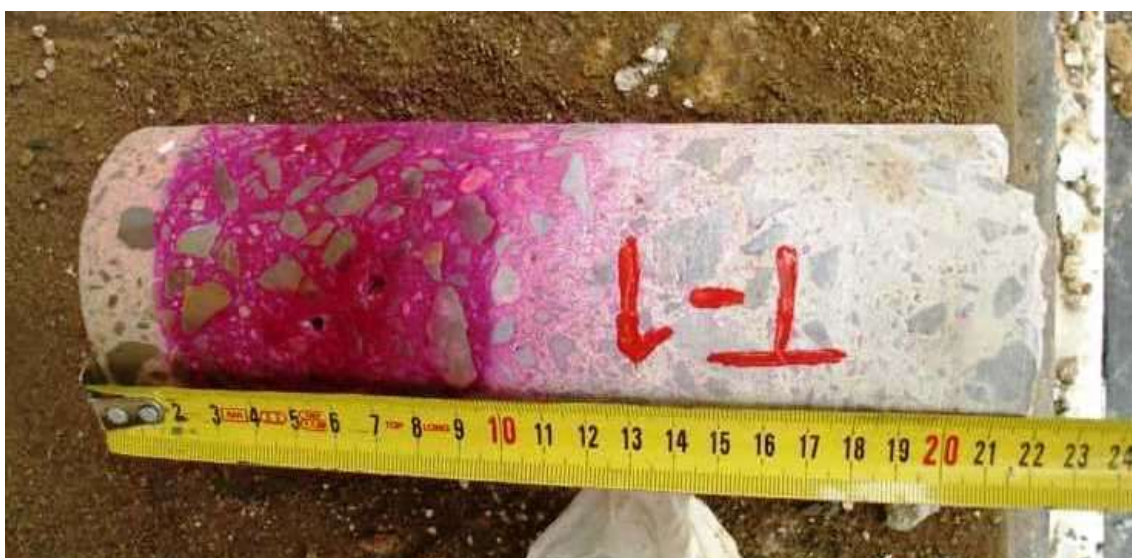
Slika 3: Prikaz meritve globine karbonatizacije na odvzetem valju s pomočjo indikatorja (fenolftalein)
