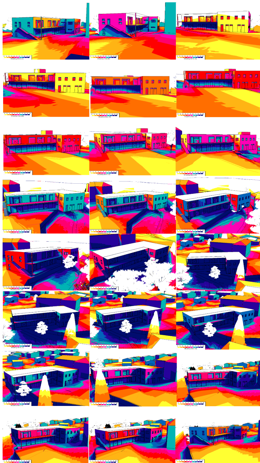
Slika B 1: Vrtenje objekta okoli svoje osi po 15° in analiza senc z vtičnikom Shadow Analysis
