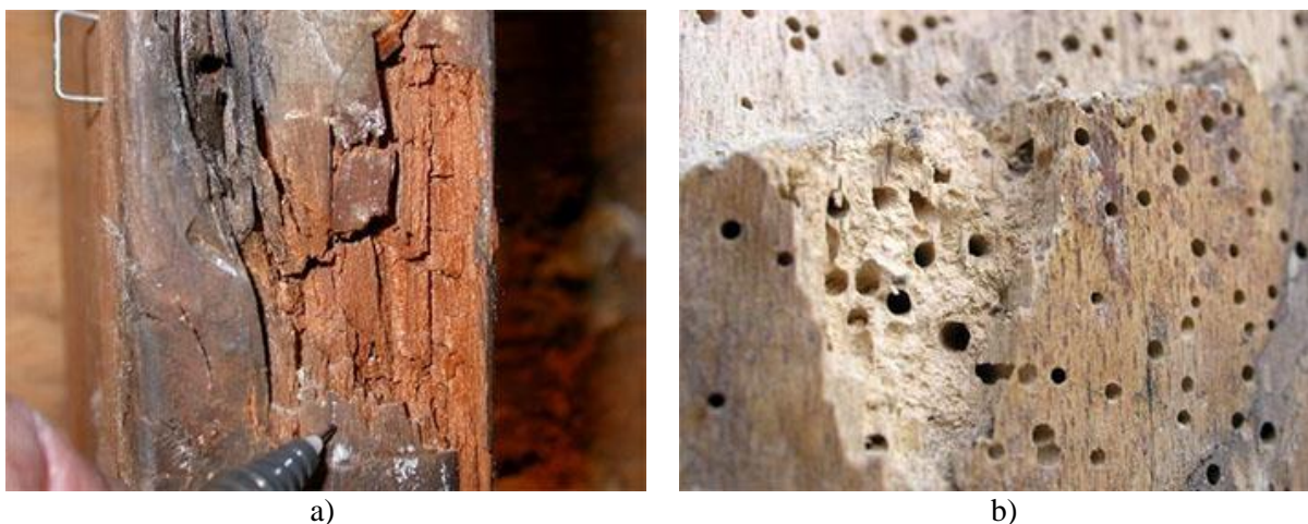
Slika 16: a) rjava trohnoba, b) luknjice v lesu so posledica delovanja navadnega trdoglavca
