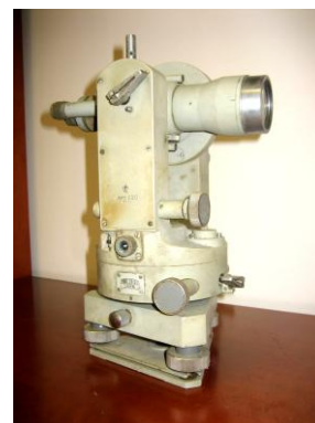
Slika 18: Teodolit Karl Zeiss Theo-020
