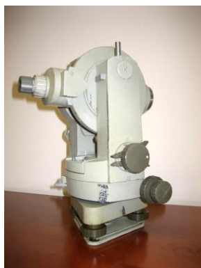
Slika 19: Avtoredukcijski tahimeter DAHLTA 010A
