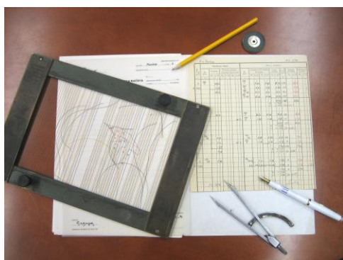
Slika 27: Nitni planimeter in tabela izračuna površin v elaboratu KO Ponikve
