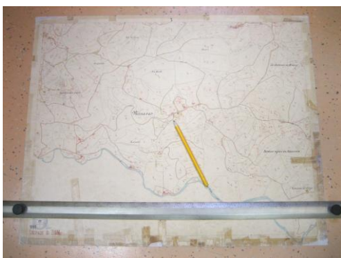
Slika 29: Merilo, ki je omogočalo direktno odčitavanje skrčka detajlnega lista – originala
