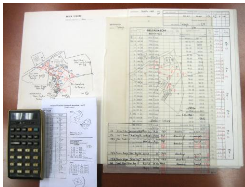
Slika 23: Računalnik HP 25 (program za izračun polarnih koordinat je bilo potrebno po korakih vtipkati v računalnik) in elaborat iz leta 1980
