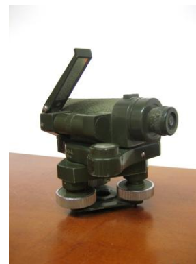
Slika 22: Nivelir Karl Zeiss Ni 060
