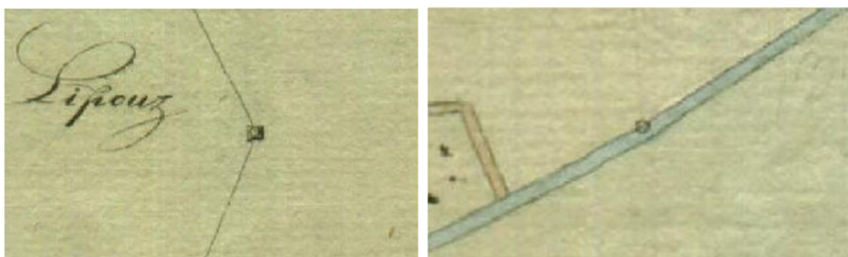
Slika 28: Izrezi iz nartov franciscejskega katastra, na katerih so označene različne vrste triangulacijskih točk (Vir: ARS; lasten prikaz)
