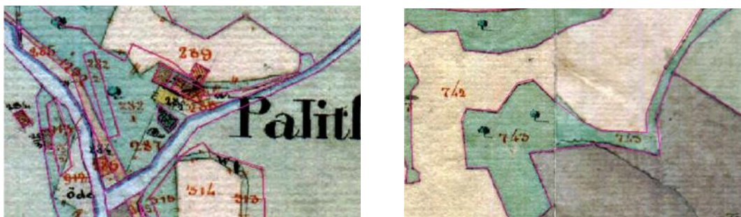
Slika 16: Prikaz težav pri zajemanju parcel: levo – slabo vidne meje, desno – neujemanje meje na stiku listov (Vir podatkov: ARS; lasten prikaz)
