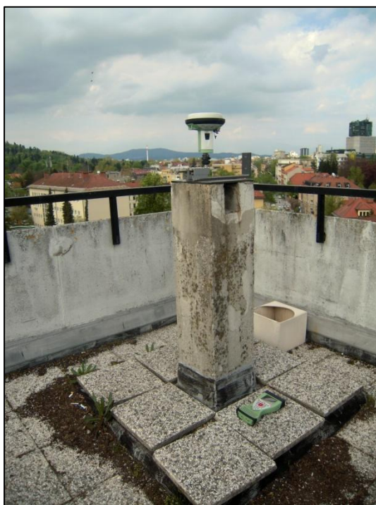
Slika 5: Točka FGG2, na kateri smo preko kovinskega nosilca izvajali premike
