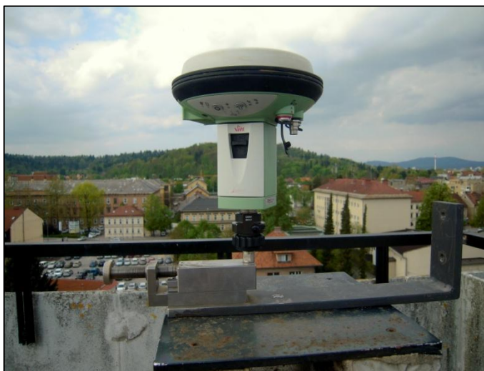
Slika 4: Kovinski nosilec, na katerem je pritrjena antena sprejemnika GNSS
