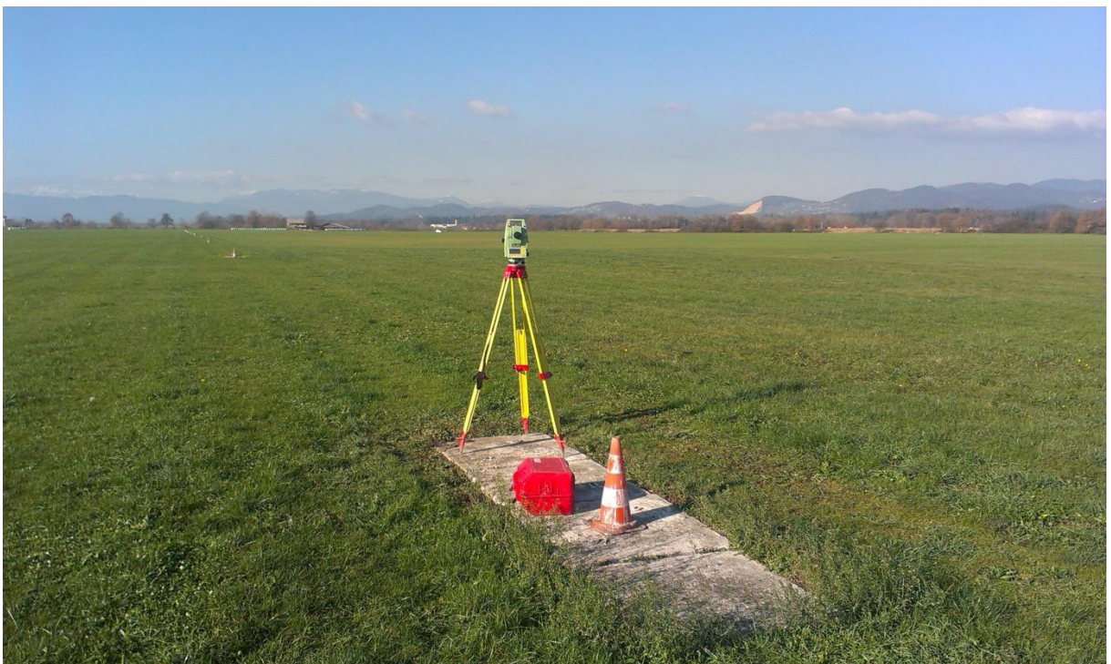
Slika 10: Prikaz stojišča tahimetra pri razdalji 400 m in 600 m
