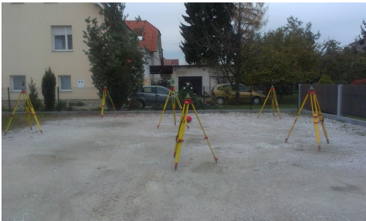
Slika 8: Prikaz postavitve tahimetra in točk pri razdalji 5 m
