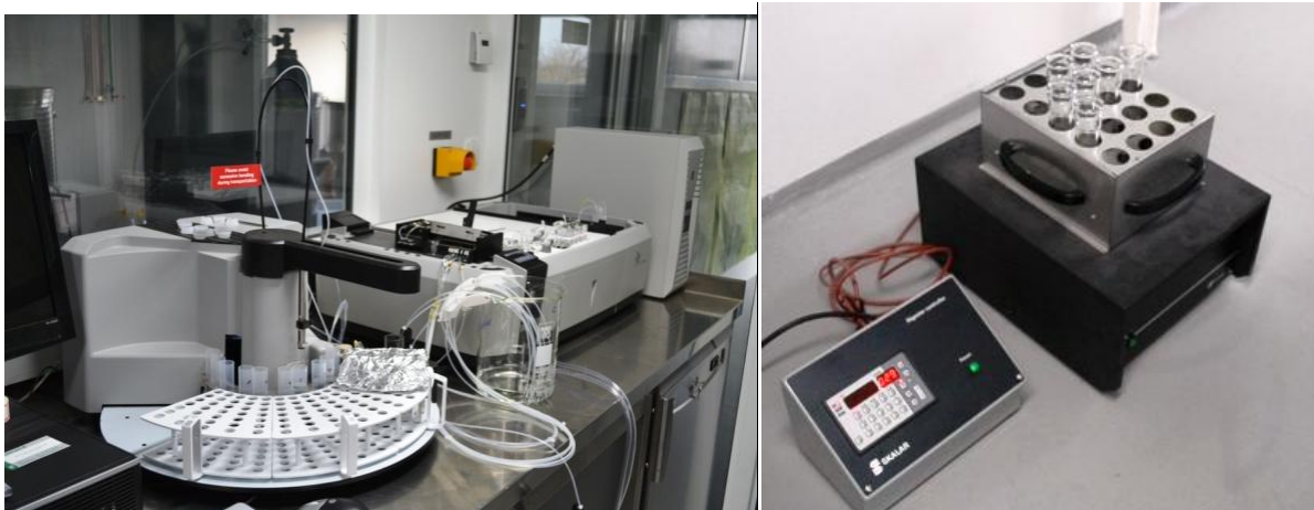
Slika 30: Skalar San++ za merjenje dušika in amonijskega dušika (levo) in enota za razklop dušika Modelno merilno SA5620 in SA5640 (desno).
