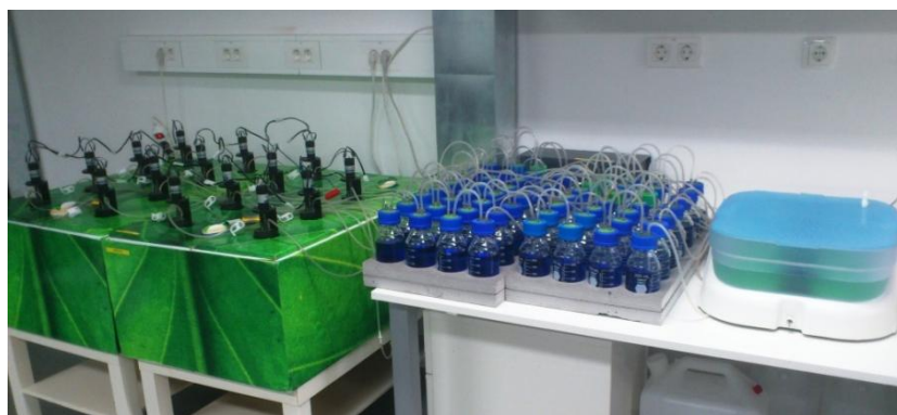
Slika 29: AMPTS II na 5 l modelnem merilu.
