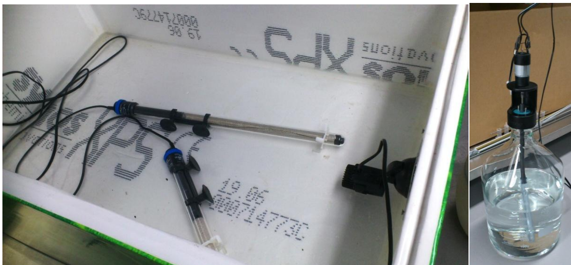
Slika 39: Termostatska vodna kopel za 5 l reaktorje, narejena iz vodo nepropustnega stiropora. V kopeli sta grelnika za gretje vode in mešalo za kroženje vode (levo) in podaljšanje mešala v 5 l reaktorju (desno) (Kolbl et al. 2014).
