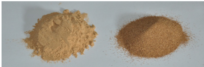
Slika 3.4: Mleta lešnikova lupina kot suspendirana snov: levo fini delci, desno grobi delci
