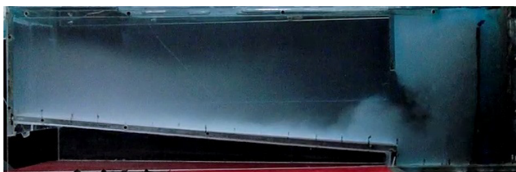
Slika 4.10: Stanje v usedalniku; pretok 4 l/min; steklene kroglice zrnivosti C; nazivna utežna koncentracija 2 %; stanje po šestih minutah.
