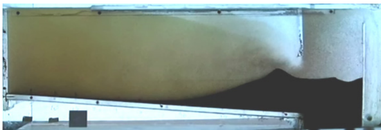
Slika 4.9: Stanje v usedalniku; pretok 4 l/min; grobo mleta lešnikova lupina; nazivna utežna koncentracija 2 %; začetno stanje.
