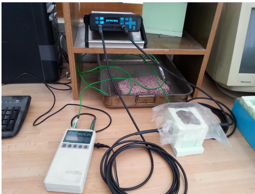
Slika 18: Določitev časa vezanja z uporabo ultrazvočnega valovanja
