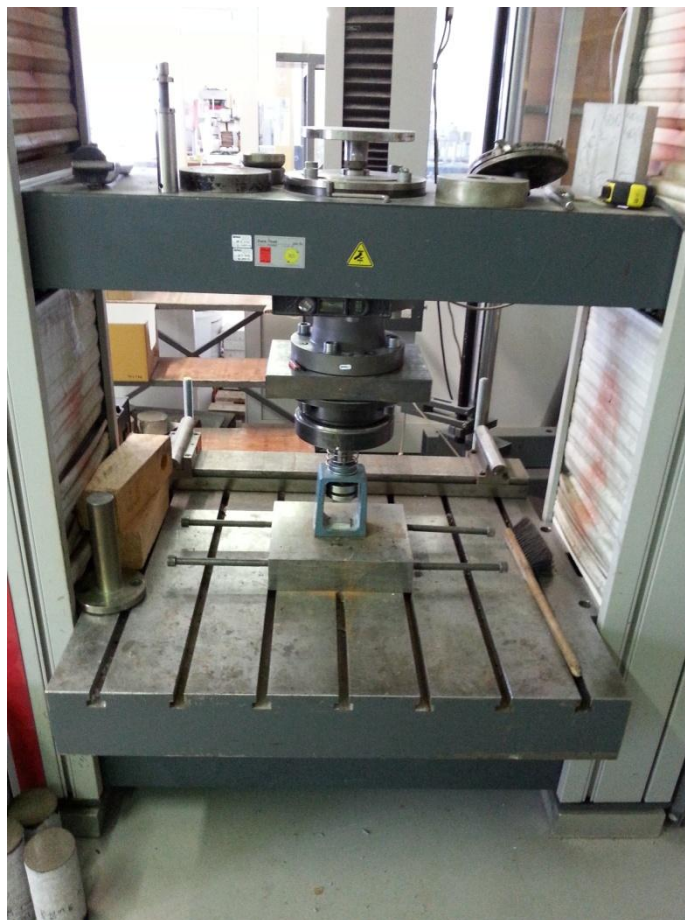
Slika 17: Preskuševalni stroj Zwick 400
