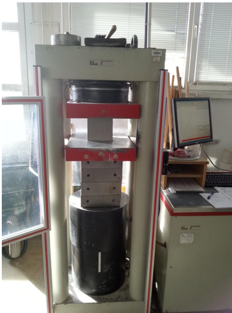
Slika 16: Preiskava tlačne trdnosti z destruktivno metodo
