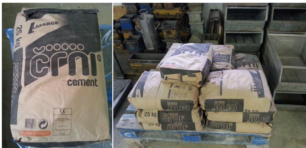
Slika 10: Uporabljeni cement CEM I 42,5 R
