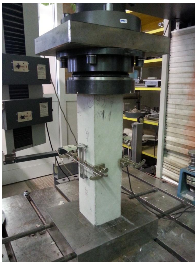
Slika 13: Določanje statičnega elastičnega modula E_s
