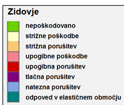
Slika 3-32: Legenda za vrste poškodovanosti konstrukcije
