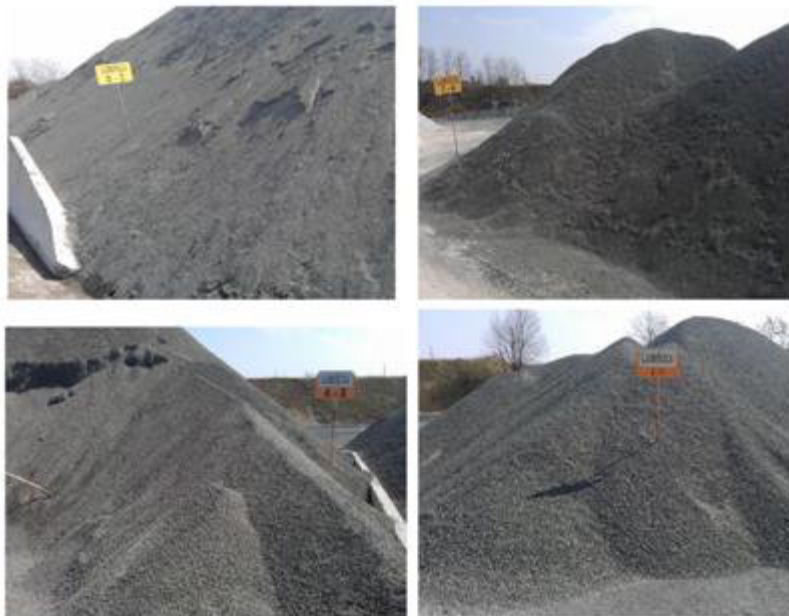
Slika 3.2.2.1: Deponije frakcij kamnitih zrn v asfaltnem obratu Drnovo pri Krškem Figure 3.2.2.1: Landfill with stone aggregate fraction in asphalt plant in Krško Drnovo
