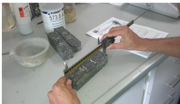
Slika 5.1.2: Meritev dolžine prizmatičnega preskušanca
