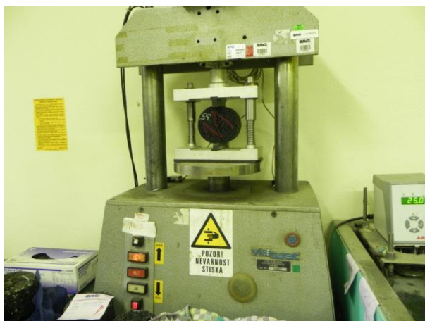
Slika 3.1.4.1: Oprema za ITS, ki jo uporabljajo na ZAG-u.
