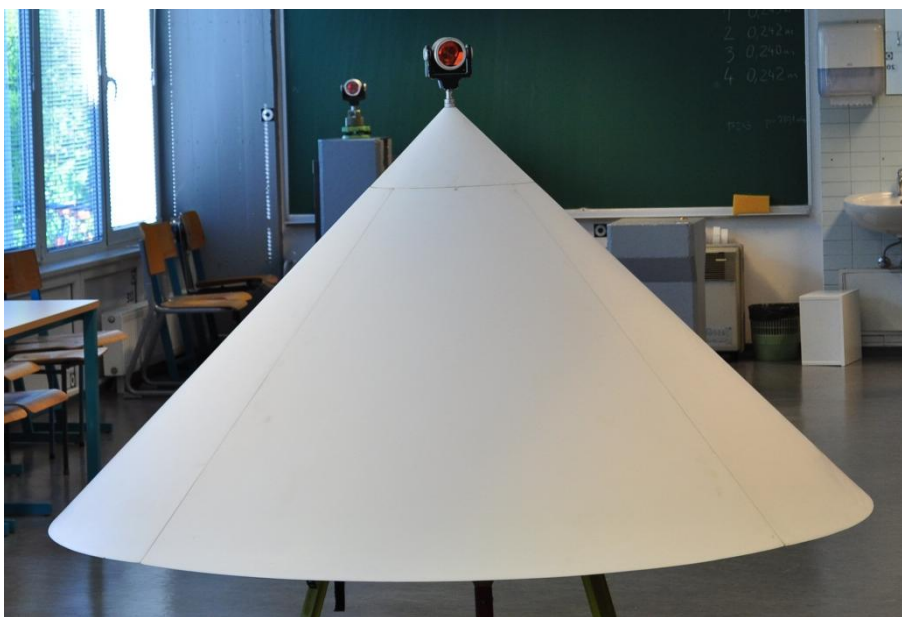
Slika 5: Primer stožca, kot talne tarče za aerolasersko skeniranje
