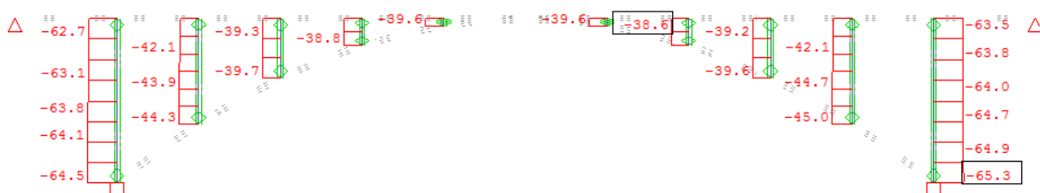
Slika 28: MSN 1: Ovojnica ekstremnih prečnih sil V_{min} [kN] in V_{max} [kN] v ločnem nosilcu.
